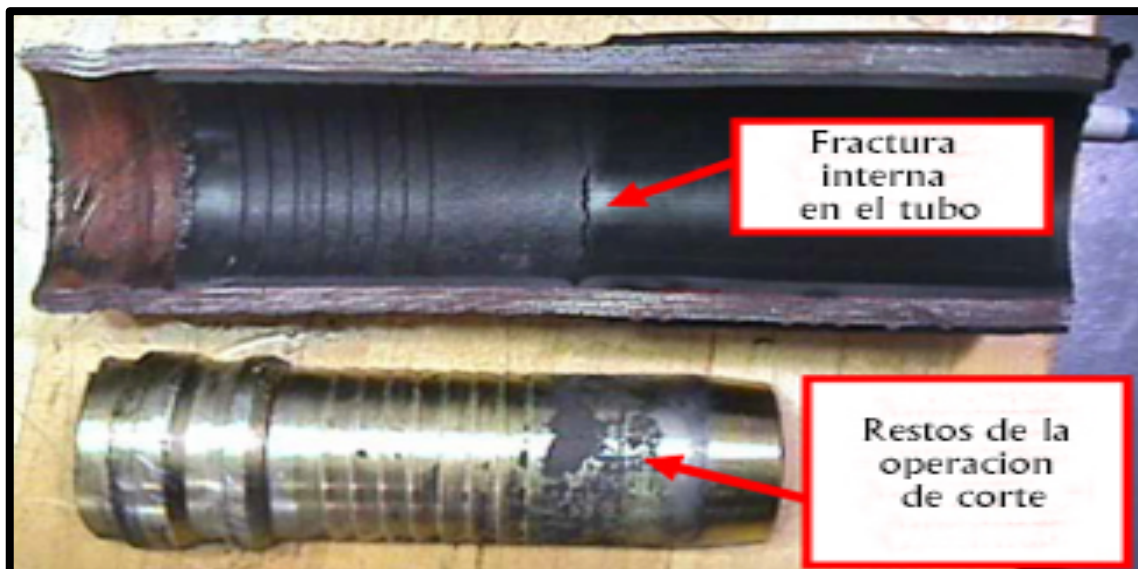
Figura 11: Mangueras con pequeñas fracturas.
