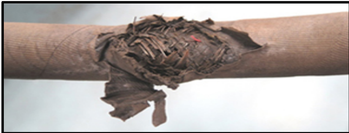
Figura 13: Manguera con la cubierta reventada
