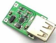
**Figura 20:** Modulo Step-Up DC/DC 5V USB
