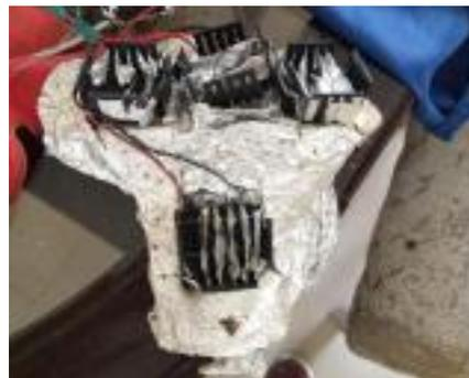
**Figura 13:** Arreglo de 4 celdas con más capas de aislante
