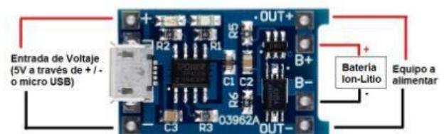
**Figura 19:** Módulo TP4056 y su esquema de conexión
