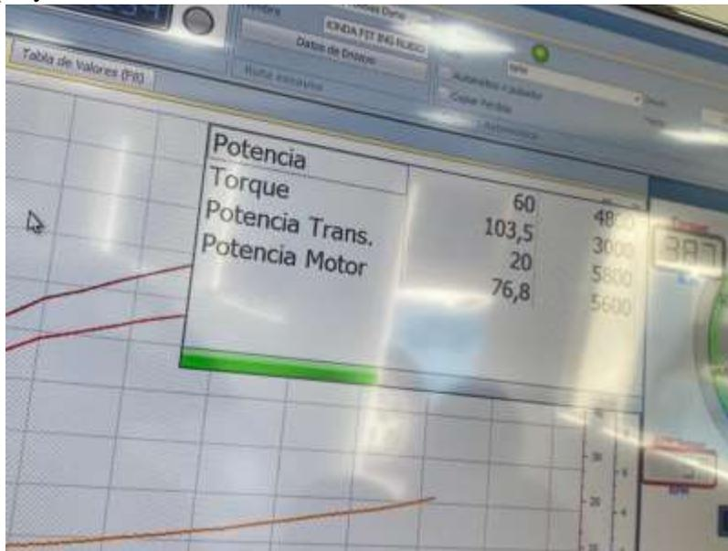
**Anexo 20** Torque y Potencia vs Revoluciones: 80 HP
