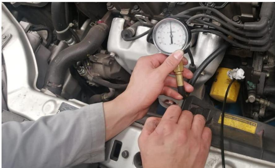
Figura A.3. Medición de compresión mecánica
