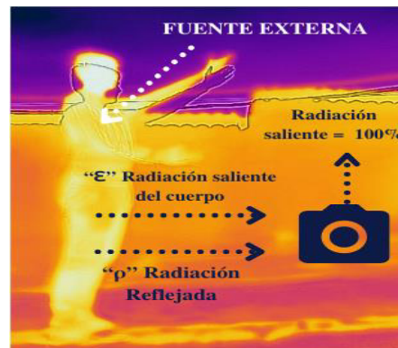
Figura. 3 Flujo de energía para medición termográfica.
