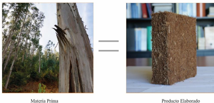
AISLANTE A PARTIR DE CORTEZA DE EUCALIPTO
