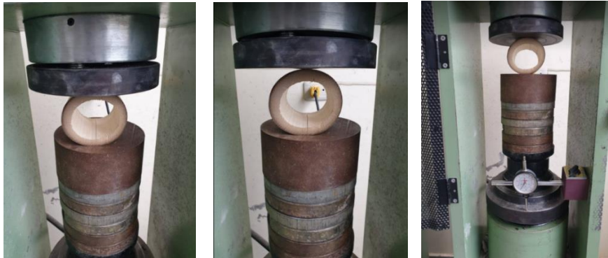
Figura 46. Ensayo a compresión perpendicular a la fibra
