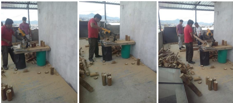
Figura 35. Corte de probetas
