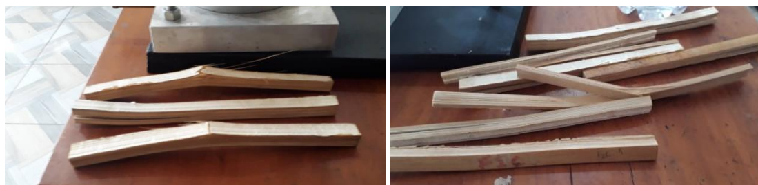
Figura 53 Probetas expuestas a flexión
