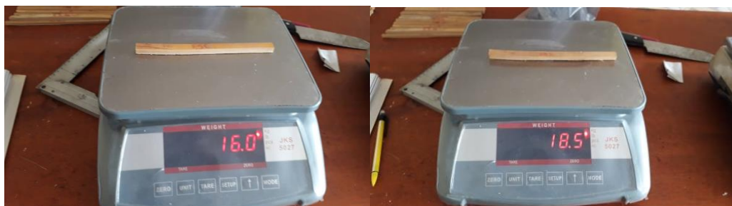
Figura 40. Pesaje de probetas, contenido de humedad
