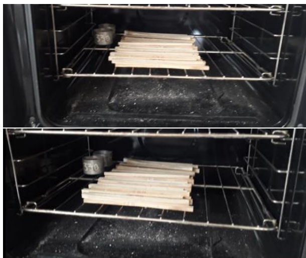
Figura 41. Secado para pesaje posterior de probetas, contenido de humedad
