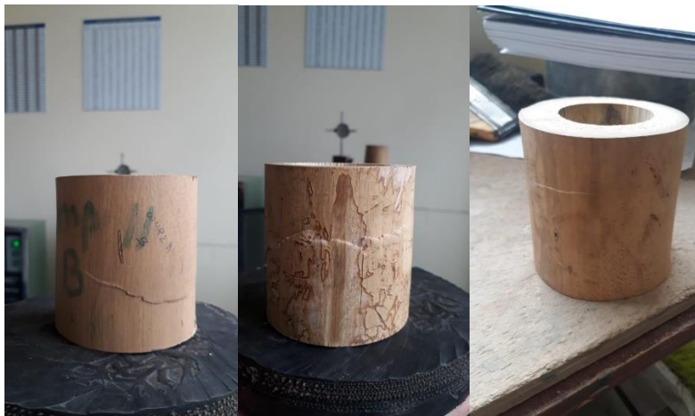
Figura 44. Probetas expuestas a compresión paralela a la fibra
