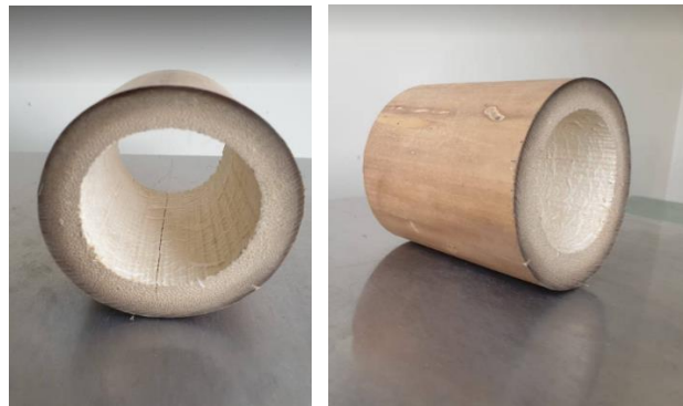
Figura 47. Probetas expuestas a compresión perpendicular a la fibra
