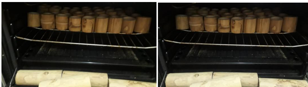
Figura 39. Secado artificial de probetas
