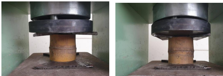
Figura 49. Ensayo a corte paralelo a la fibra
