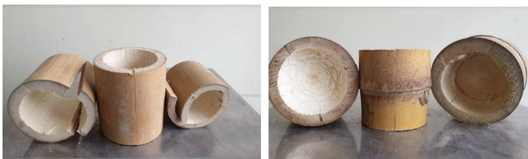
Figura 50. Probetas expuestas a corte paralelo a la fibra
