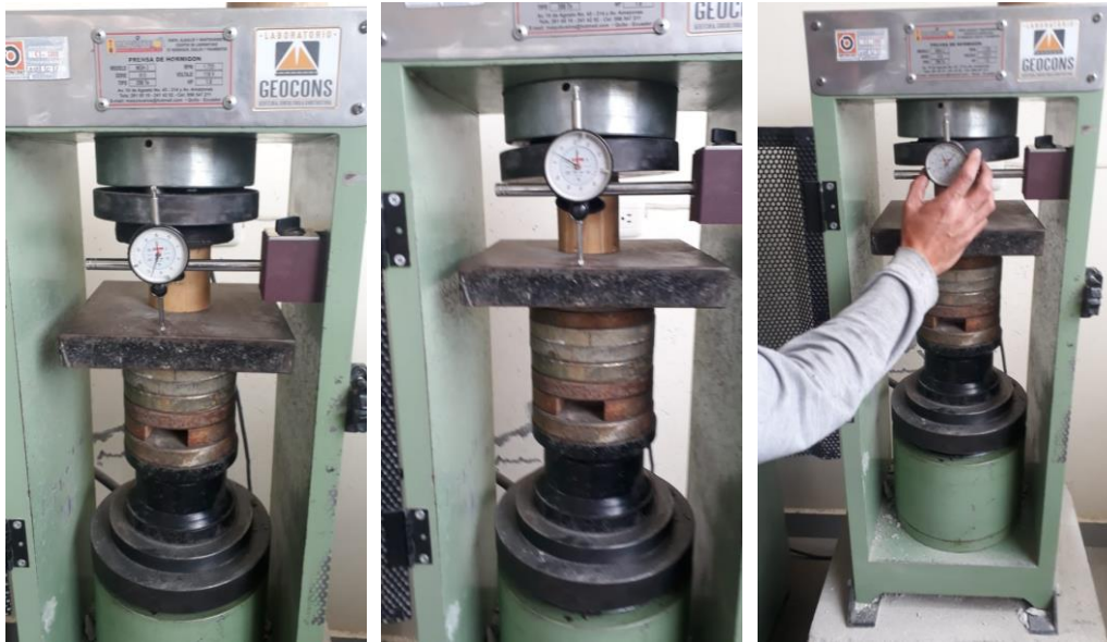
Figura 43. Ensayo a compresión paralelo a la fibra
