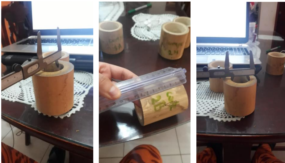
Figura 37. Registro y medida de probetas
