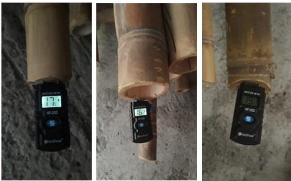
Figura 38. Control de humedad de elementos
