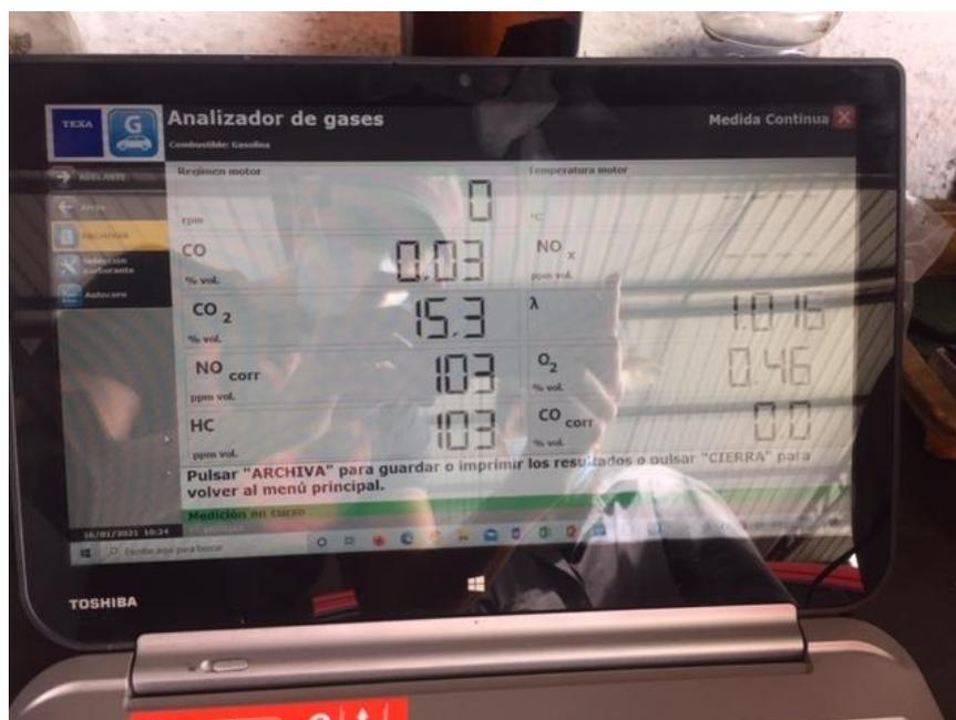
**Figura 16.** Pruebas de análisis de gases de Toyota Prius Csport
