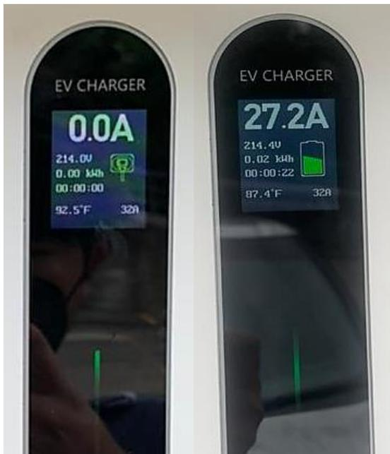
Se pudo verificar en el interior del vehículo este proceso mediante los indicadores que se encuentran encima del tablero y en el display el cual indica que la batería empezó a cargar
