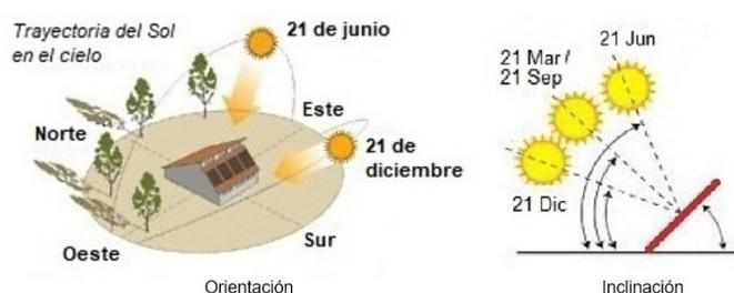
**Figura 21.** Orientación e inclinación de paneles [9]
