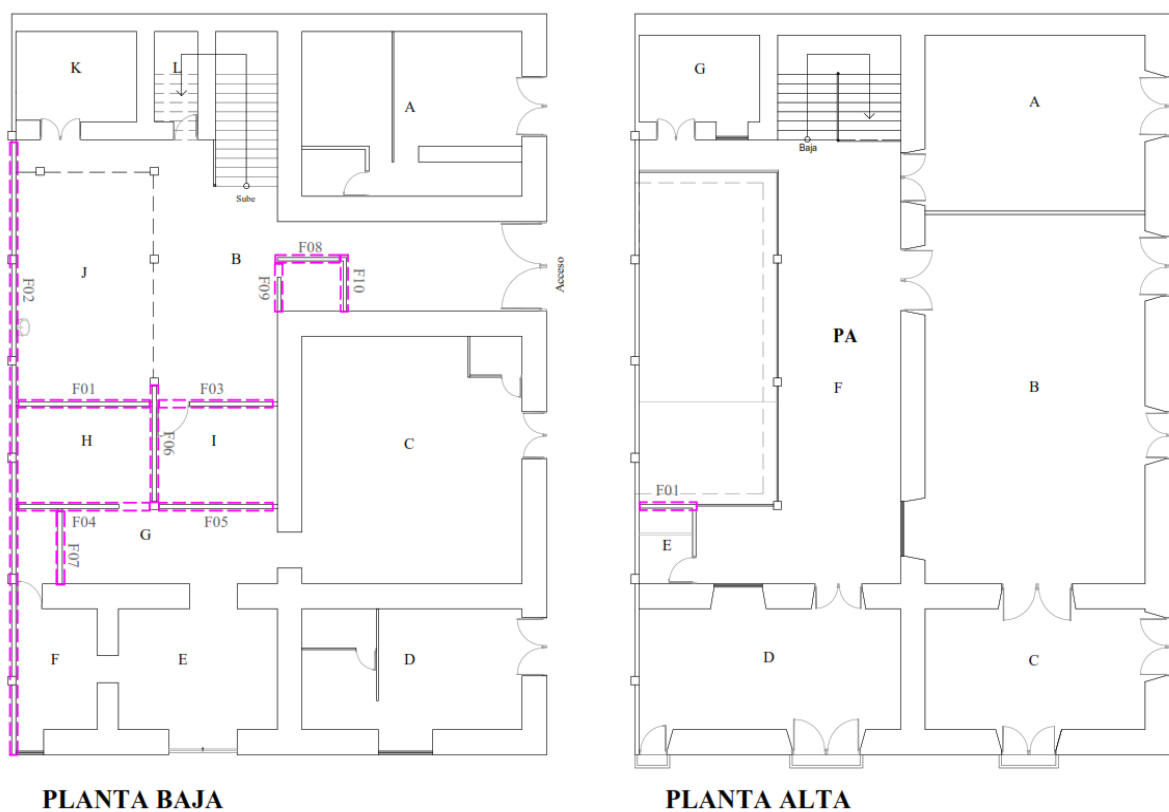
Figura 46. Estado de conservación del elemento paredes
