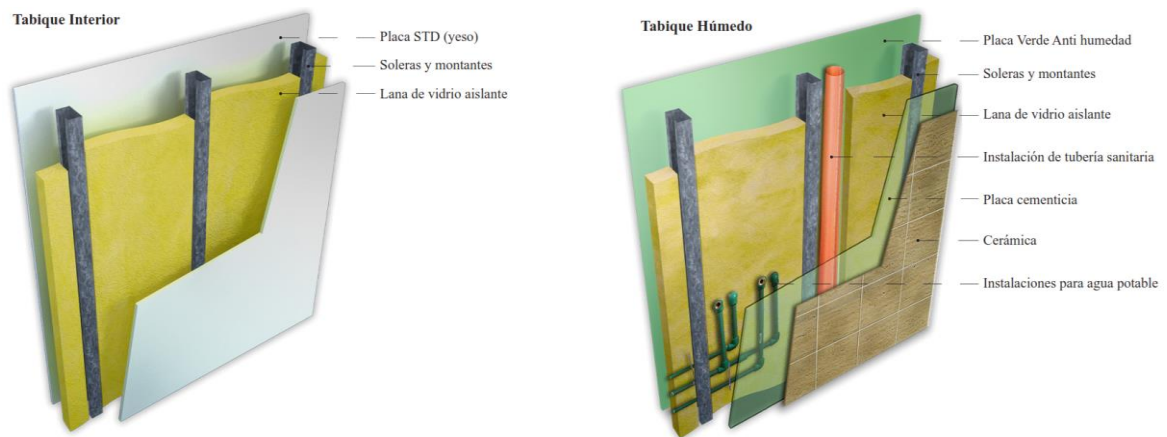
Figura 57. Sistema Steel framing
