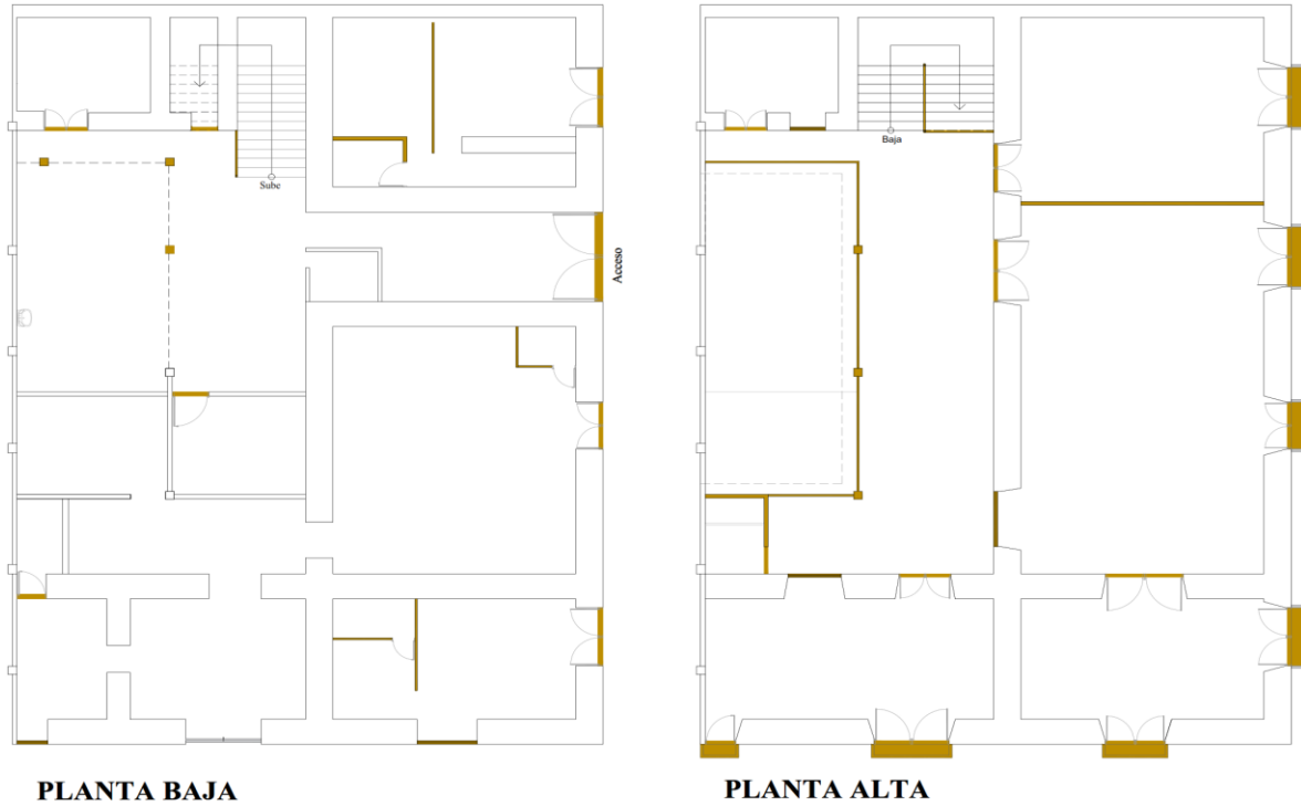
Figura 40. Elementos constitutivos identificados en la vivienda, carpintería.
