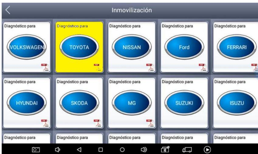
Después de haber ingresado en la marca del vehículo, el siguiente paso presenta cuatro opciones: control remoto, inmovilizador, sistema de llave inteligente y llave inteligente perdida. Para este proceso, presionar ENTER en la opción inmovilizador, como se muestra en la figura 77.
