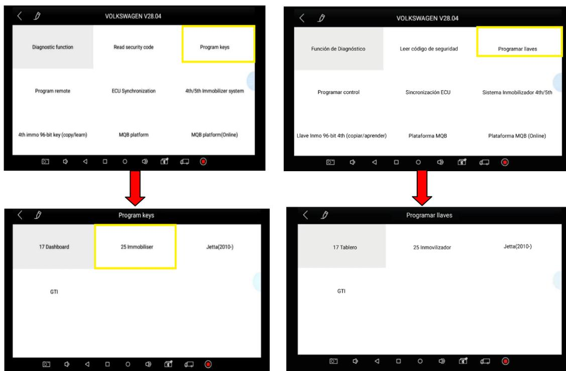
Una vez realizada la selección del inmovilizador, aparece el mensaje que indica que se debe girar la llave a la posición apagado y luego volver a colocar la llave en la posición de ignición. Seleccionar OK para continuar, como se muestra en la figura 52.
