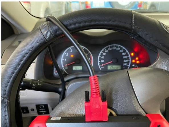
Una vez que se encuentra conectado el equipo programador, encender el mismo y presionar el botón de la función diagnóstico, luego se presenta una ventana con las funciones del equipo. Seleccionar la función de inmovilización, como indica la figura 75.
