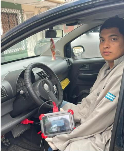
Colocar el switch de encendido en la posición abierta; es decir, observando que las luces testigo del tablero estén encendidas, como se muestra en la figura 44.
