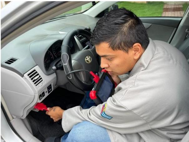
Colocar el switch de encendido en la posición abierta; es decir con las luces testigo del tablero encendidas, como indica la figura 74.
