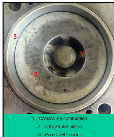
Figura 14: Cámara de combustión
