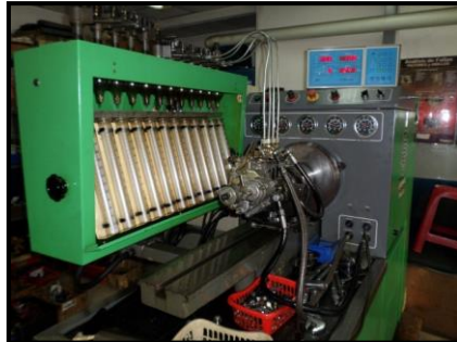
Figura 73: Comprobación de la bomba de inyección
