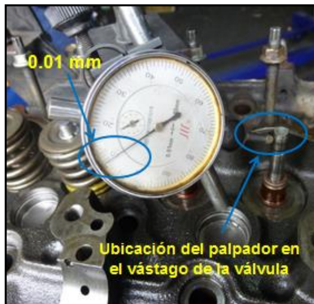
Figura 40: Verificación de holgura entre vástago y guía de válvulas
