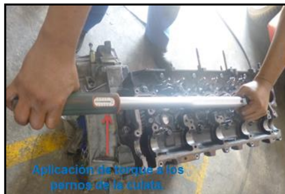
Figura 69: Aplicación del torque de ajuste de los pernos de la culata
