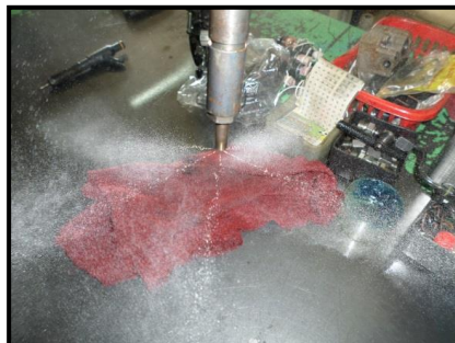
Figura 74: Verificación de atomización del inyector
