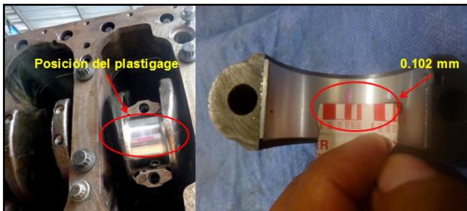
Figura 60: Comprobación de holgura de cojinetes y muñequillas de biela
