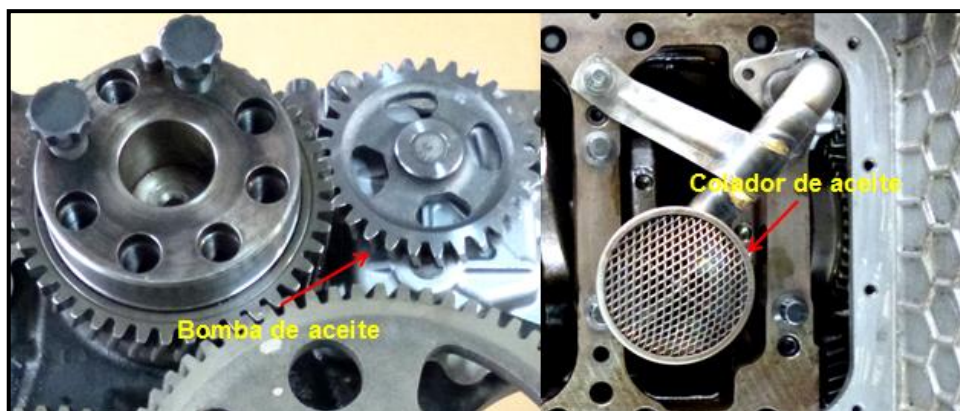
Figura 61: Montaje de la bomba y colador de aceite
