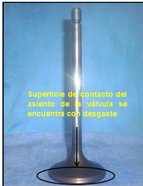
Figura 42: Desgaste de la superficie del asiento de la válvula
