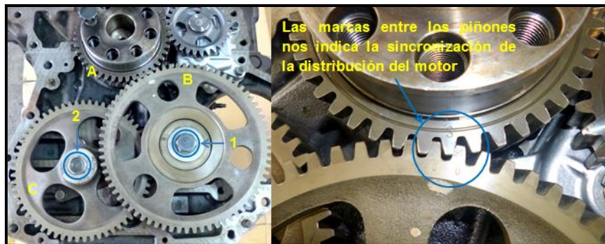
Figura 62: Sincronización de la distribución del motor
