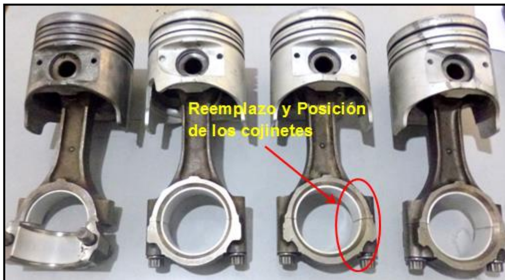
Figura 58: Montaje de los cojinetes de las muñequillas de biela
