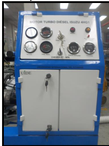
Figura 93 Montaje del tablero de instrumentos
