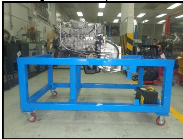
Figura 89: Montaje del motor
