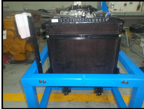
Figura 90: Montaje del radiador
