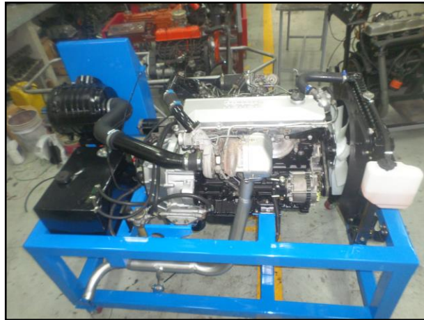
Figura 94 Montaje del Sistema de escape
