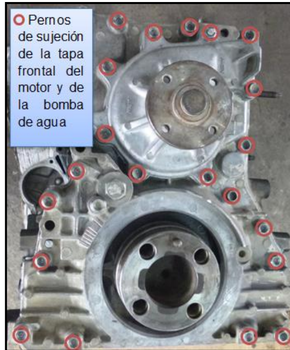
Figura 64: Montaje de la tapa frontal y bomba de agua del motor
