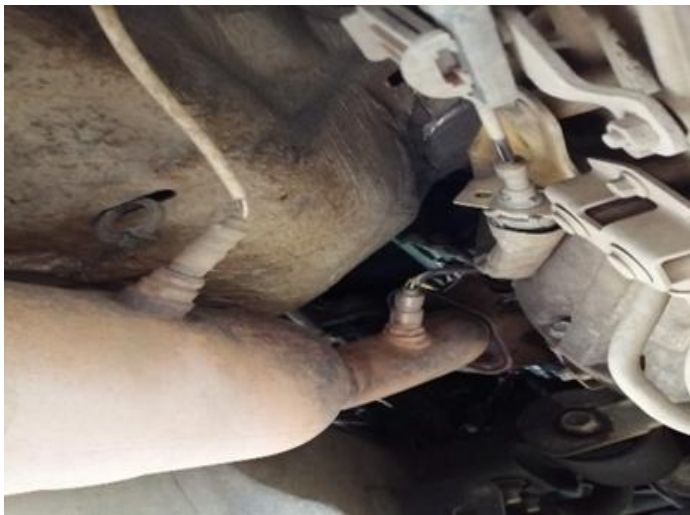
Sensores de Oxígeno antes y después del Catalizador
