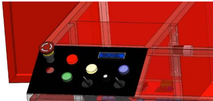
Figura. 4.3. Estructura en SolidWorks del panel de control del banco de pruebas. Ribadeneira, D; Heredia, E; Ríos, B 2020.
