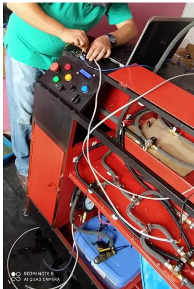
Figura. 4.20. Ensamblaje de parte eléctrica y electrónica del banco de pruebas. Ribadeneira, D; Heredia, E; Ríos, B 2020.
