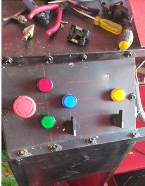
Figura. 4.15. Instalación de panel de control banco de pruebas.
