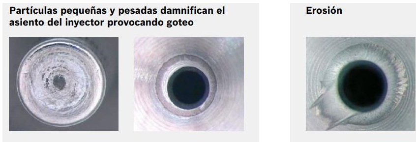
Figura 2.27. Daños ocasionados por una mala filtración.
