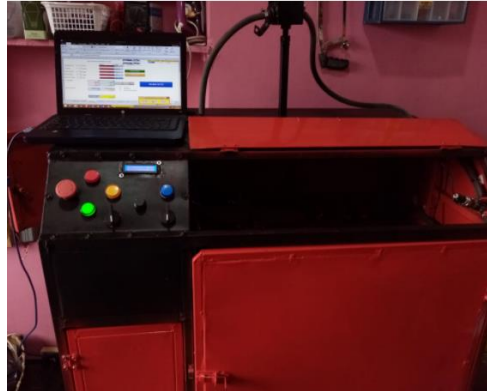
Figura. 4.21. Banco de pruebas para el análisis flujo métrico de filtros de combustible.
