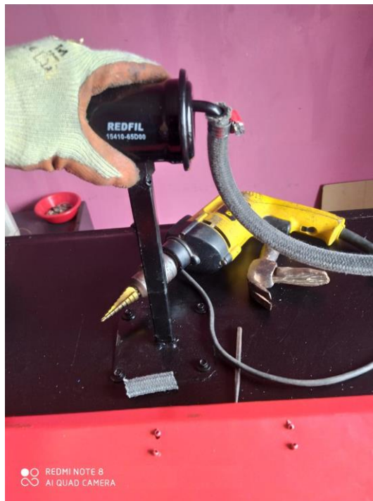
Figura. 4.14. Instalación de soporte porta filtros. Ribadeneira, D; Heredia, E; Ríos, B 2020.
