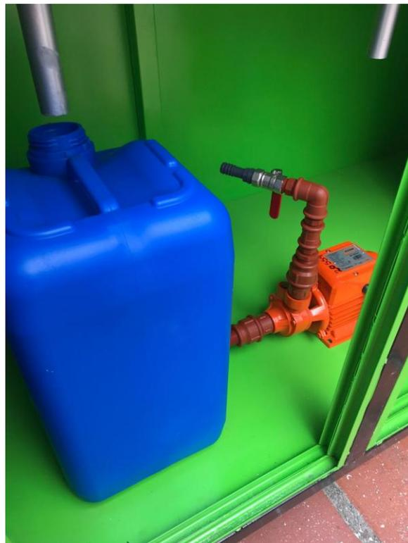
**Ilustración 46.** Apreciación frontal del sistema de limpieza accionado mediante una bomba de agua
