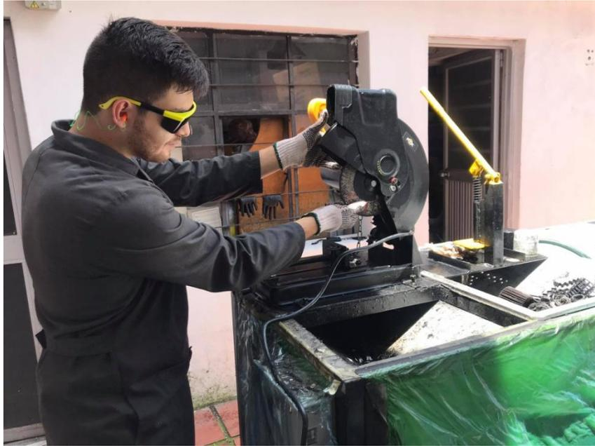
**Ilustración 57.** Verificación de apriete del disco posterior a la realización de cortes
