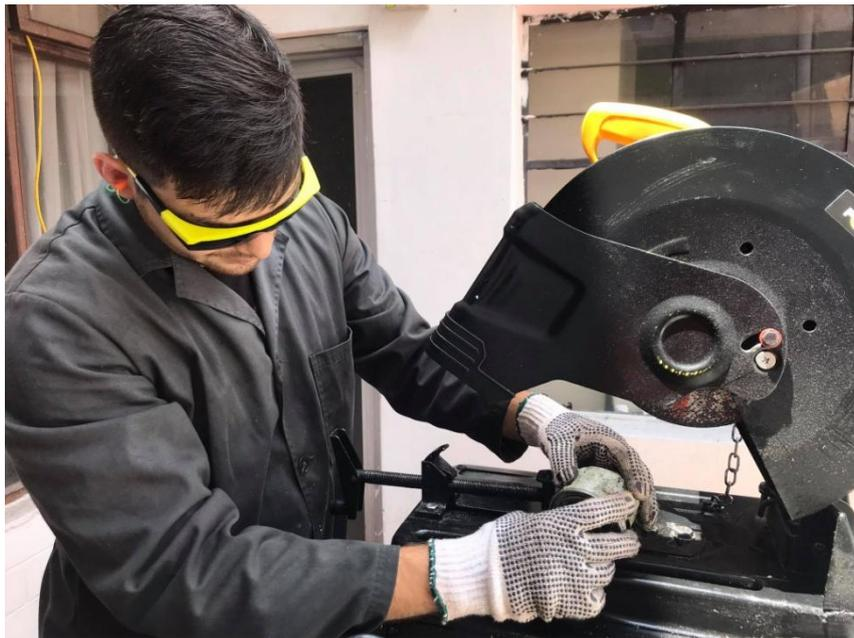
**Ilustración 54.** Ajuste de filtro previo a ser separado
