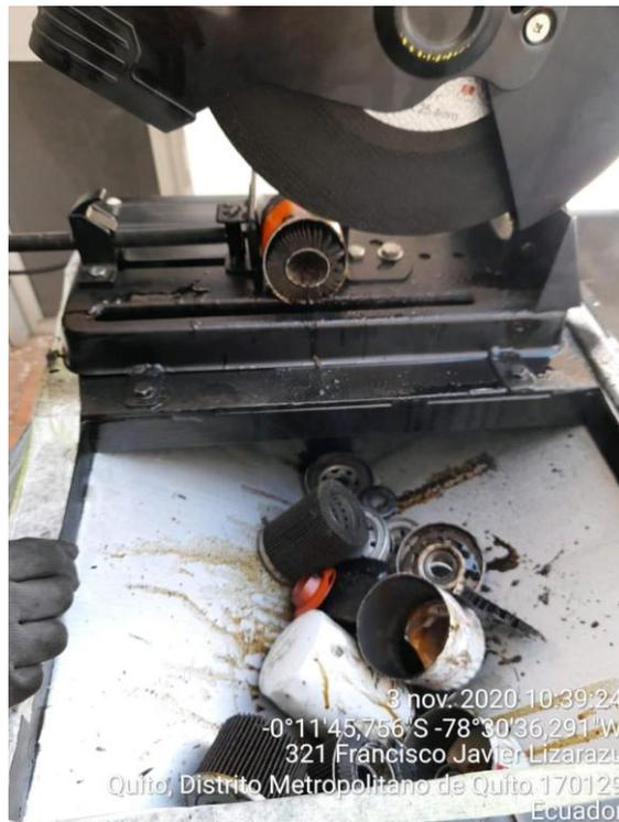
**Ilustración 56.** Filtros separados mediante el proceso de corte
