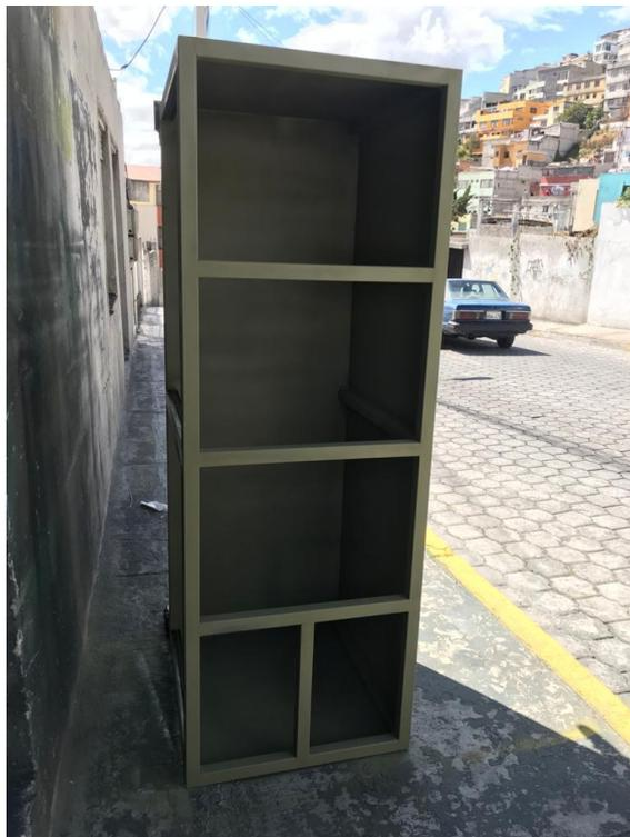
**Ilustración 19.** Colocación de pintura base previo a la añadidura del color seleccionado
