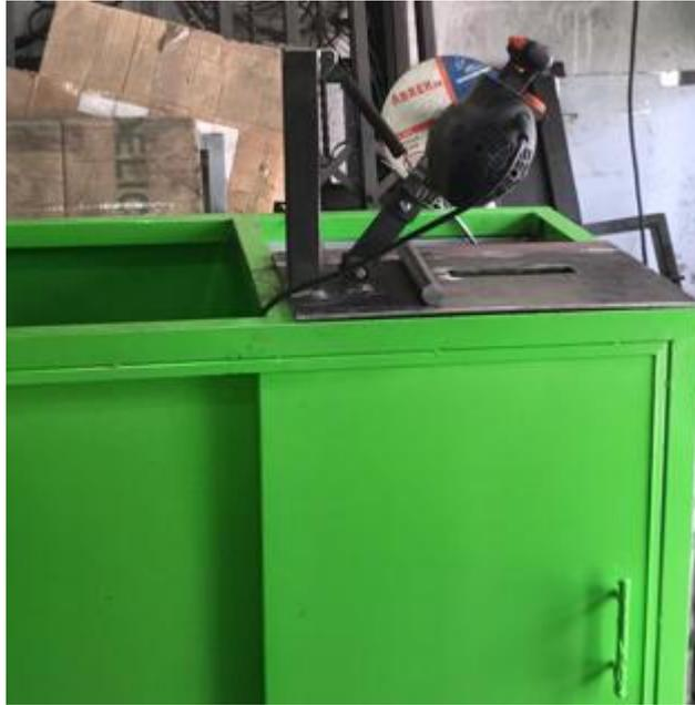
**Ilustración 29.** Vista lateral de la adaptación del sistema de corte en el banco de reciclaje
