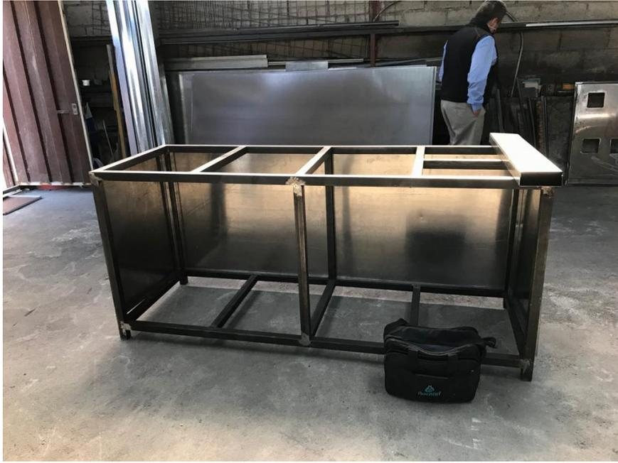
**Ilustración 16.** Ensamble de estructura y forrado de la misma mediante la implementación de tubo cuadrado y planchas galvanizadas
