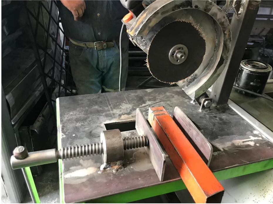
**Ilustración 31.** Prueba de corte fallada por causa de vibraciones generadas en el eje del disco
