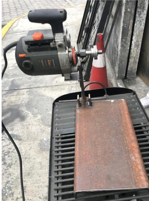
**Ilustración 27.** Vista posterior de la adaptación de motor eléctrico para el sistema de corte
