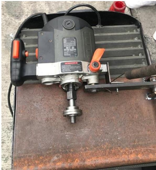
**Ilustración 27.** Vista superior de la adaptación de motor eléctrico para el sistema de corte
