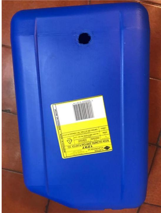
**Ilustración 43.** Perforación del reservorio para colocar conexión con la bomba
