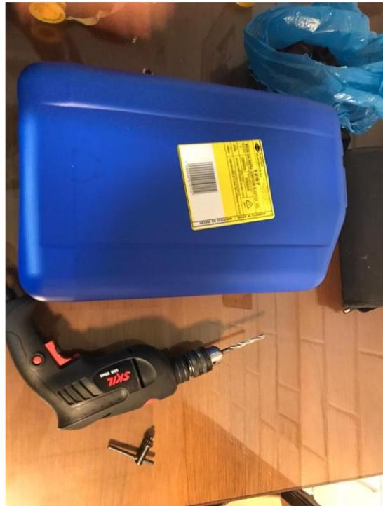
**Ilustración 42.** Herramienta implementada para realizar la perforación del reservorio
