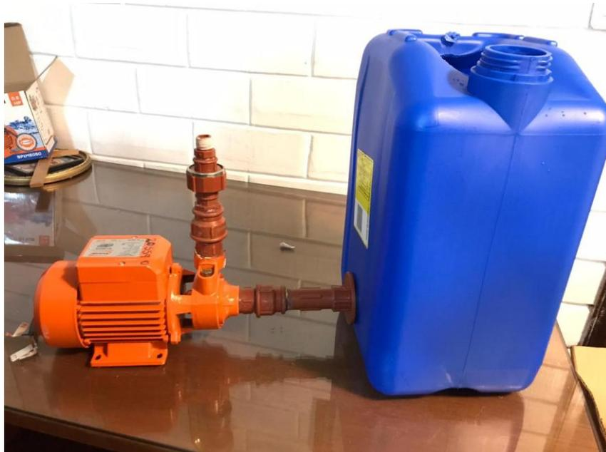
**Ilustración 44.** Conexión entre el reservorio y la bomba que comprenden el sistema de limpieza
