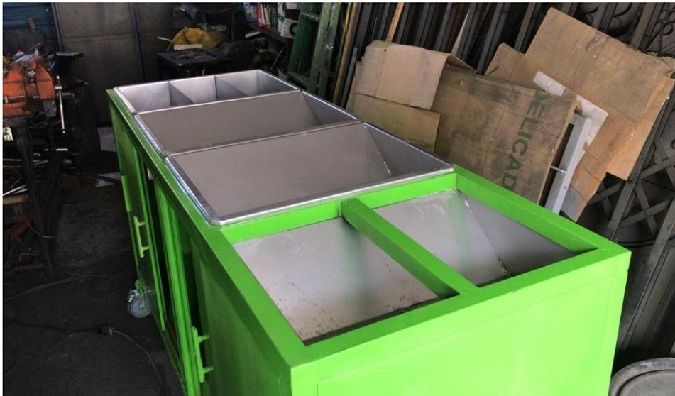
**Ilustración 25.** Colocación de lavabos y depósitos en el banco de reciclaje
