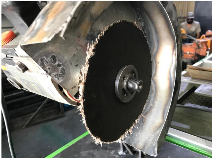
**Ilustración 32.** Falla mecánica presentada en el disco de corte
