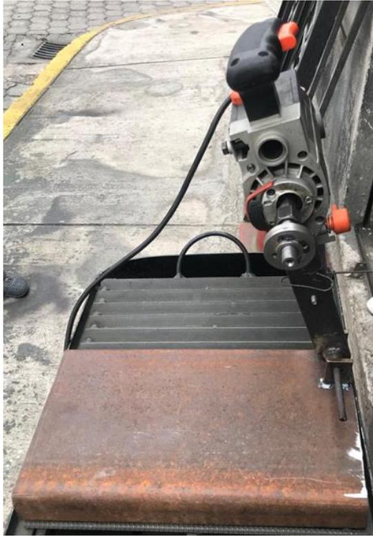
**Ilustración 26.** Vista lateral de la adaptación de motor eléctrico para el sistema de corte
