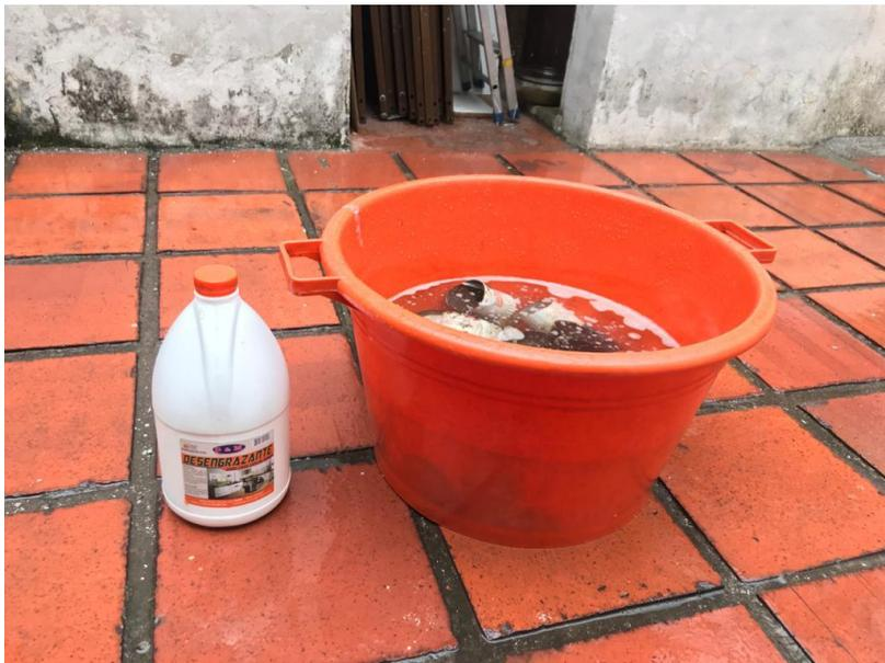
**Ilustración 58.** Limpieza de los filtros de aceite en una disolución de desengrasante automotriz
