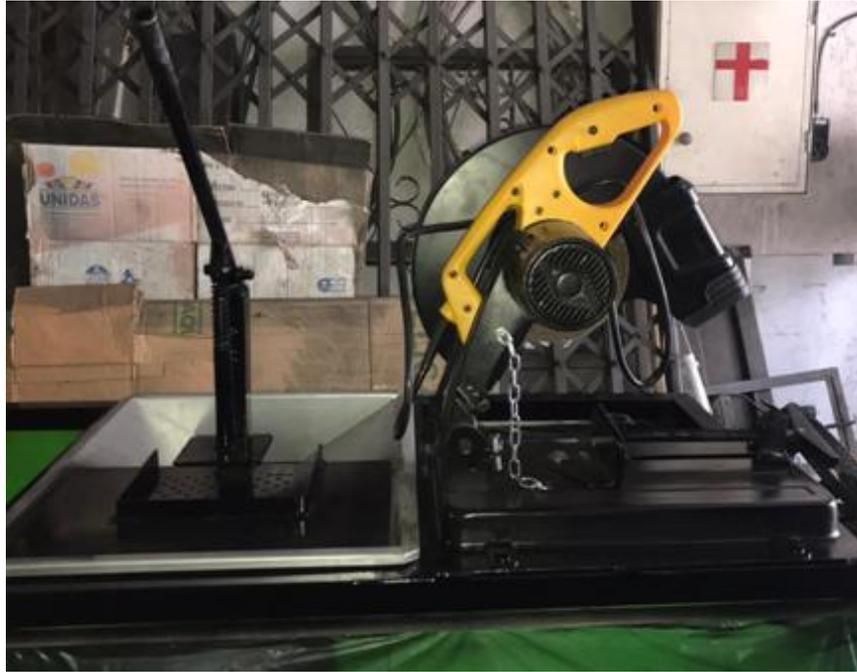
**Ilustración 35.** Sistema de corte y compactación implementado en el banco de reciclaje
