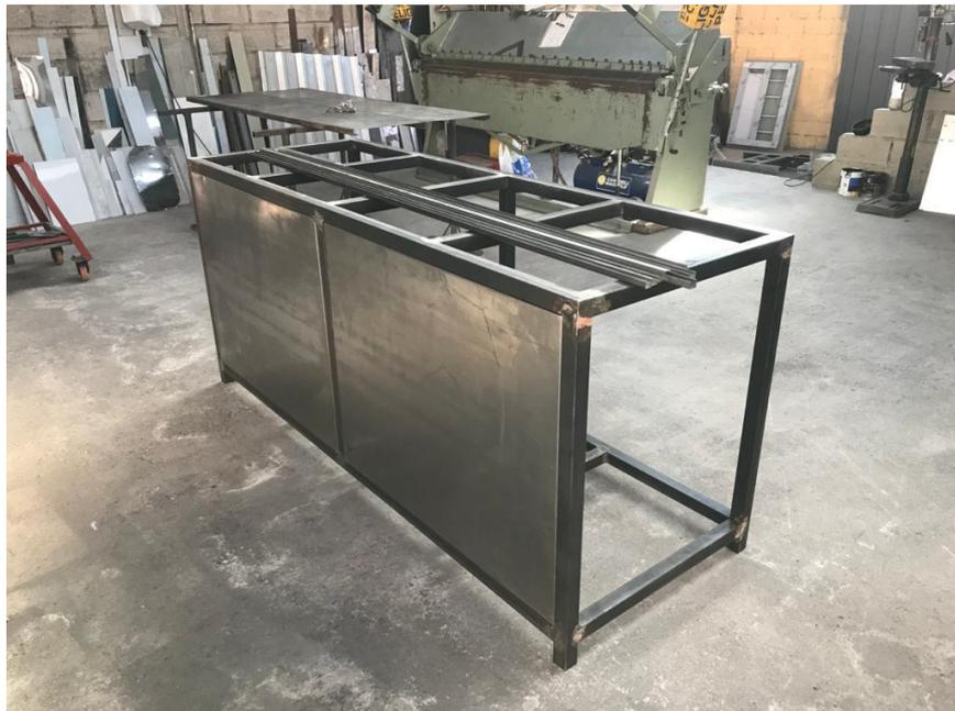
**Ilustración 17.** Vista trasera del ensamble de estructura y forrado del banco de reciclaje
