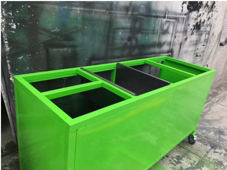
**Ilustración 21.** Aplicación de la primera capa de la pintura seleccionada
