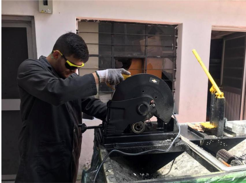
**Ilustración 55.** Proceso de separación de filtros mediante la implementación de una tronzoadora
