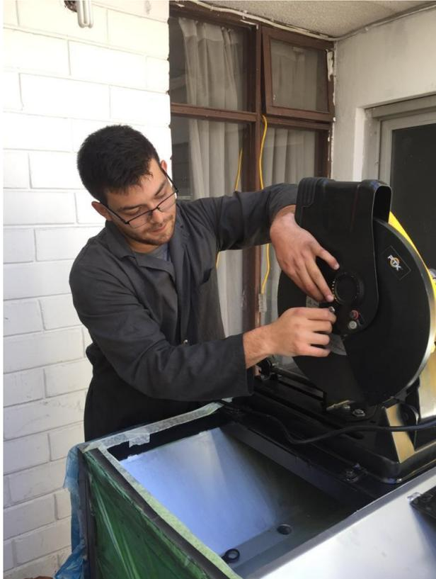
**Ilustración 51.** Verificación de apriete sobre el disco de corte previo a ser utilizado
