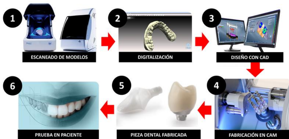
Figura 7: Protocolo básico de mecanizado de estructuras dentales.
