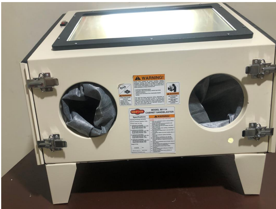
Figura 57 Parte frontal de cabina con orificios para introducir las manos a los guantes
