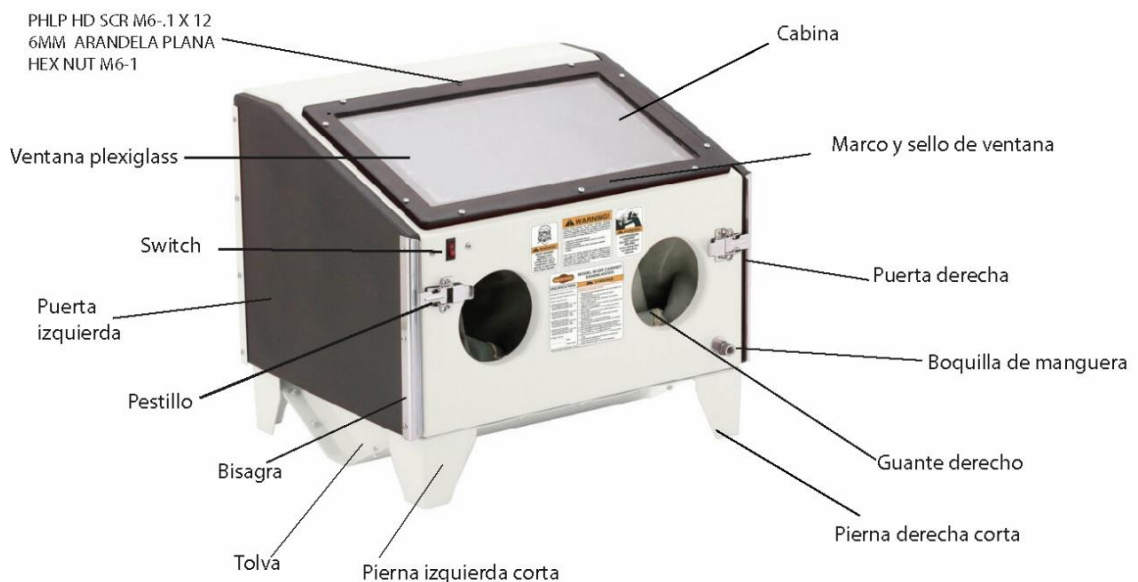
Figura 51 Esquema detallado de la cabina de arenado
