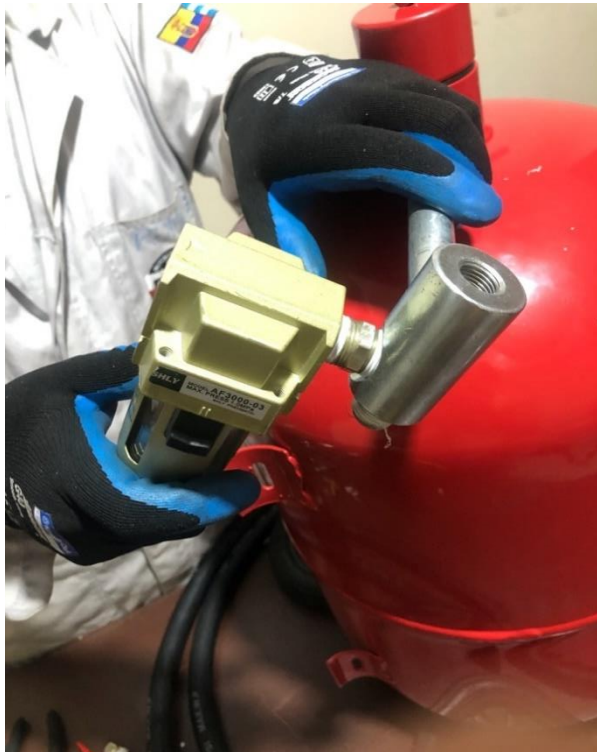
Figura 26 Colocación de filtro
