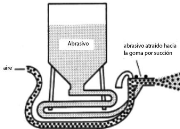
Figura 11 Esquema general del equipo de succión
