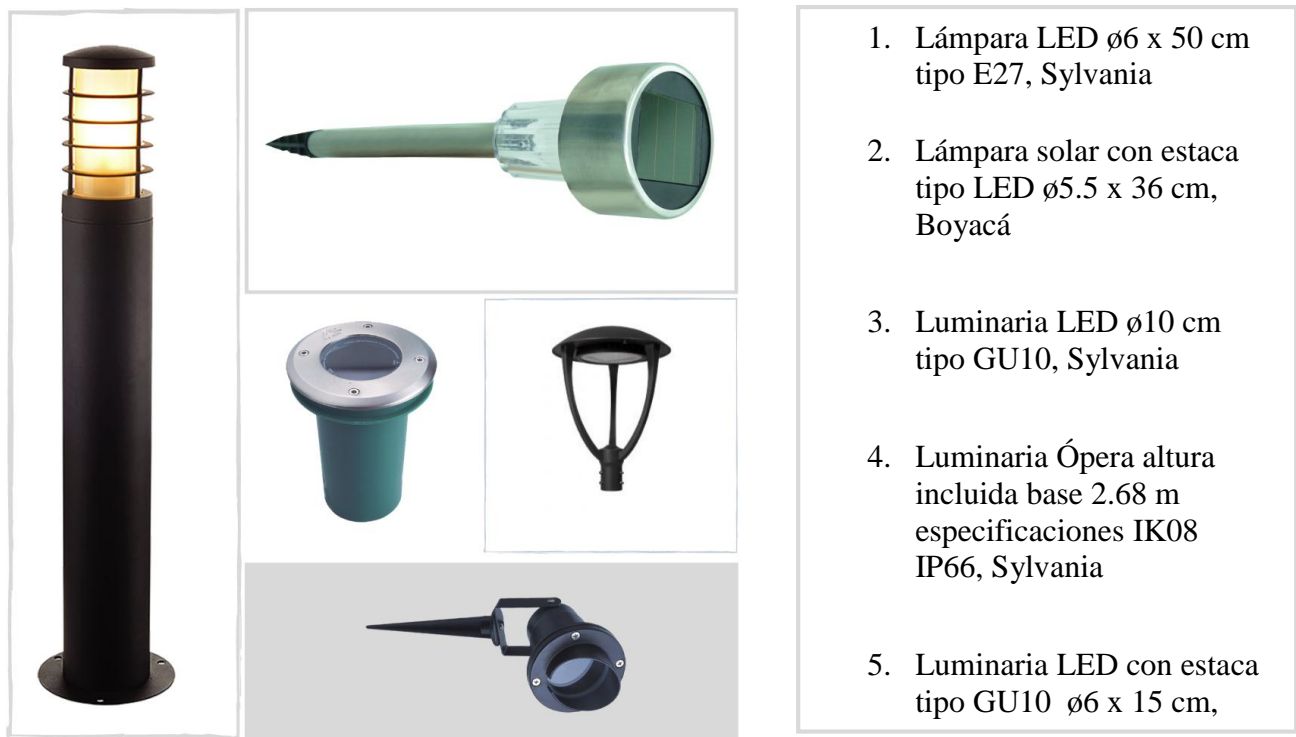
Ilustración 24 Detalle de luminarias
