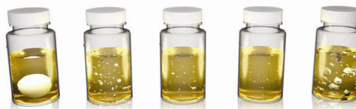
Figura 3. Relación entre el índice de densidad ferrosa y las partículas disueltas de hierro.
