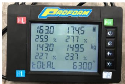
Figura 1. Medición de masa del vehículo Datsun 1000.
