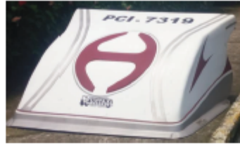
Figura 2.10. Deflector de aire para un Hino 500.
