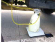
Figura 2.12. Tanque portátil de combustible.
