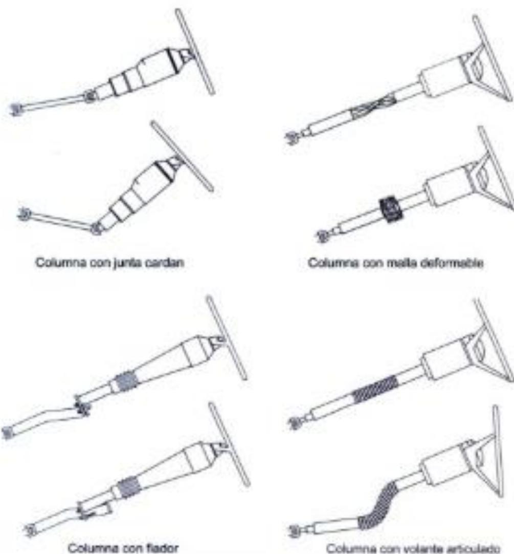
*Figura 7. Seguridad pasiva en la columna de dirección.*
