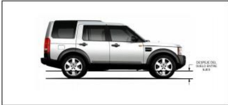
Figura 1.3.- Despeje al suelo entre ejes.
