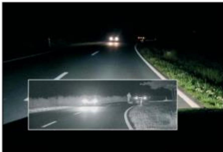
Figura 2.2.- Sistema de visión nocturna de HELLA.
