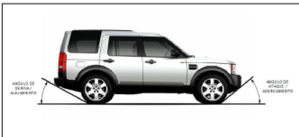
Figura 1.1.- Ángulos de ataque y deriva.
