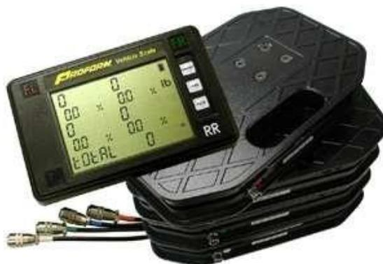
Adicionalmente, se debe verificar que la superficie este nivelada, lo que permite exactitud en la medición. Antes de tomar los valores esperamos a que alcance un equilibrio estático, luego registramos el valor de peso de cada uno de los neumáticos y en que condición se toma la medición (tanque lleno, vacío, número de pasajeros, etc.). Posteriormente, se realiza las mediciones en el vehículo para obtener la siguiente información:
