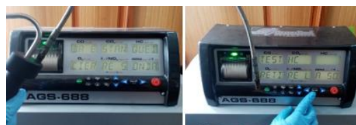
Gráfico 2: Prueba de estanqueidad y Auto calibración del equipo AGS688
