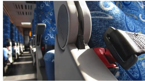
Figura 7. Cinturones en asientos de buses
