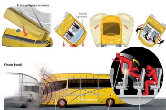
Figura 5: Impacto lateral y frontal bus
