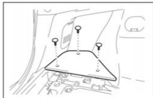
Ilustración 22: Paso 4 para el desmontaje de batería HV Toyota Prius.
