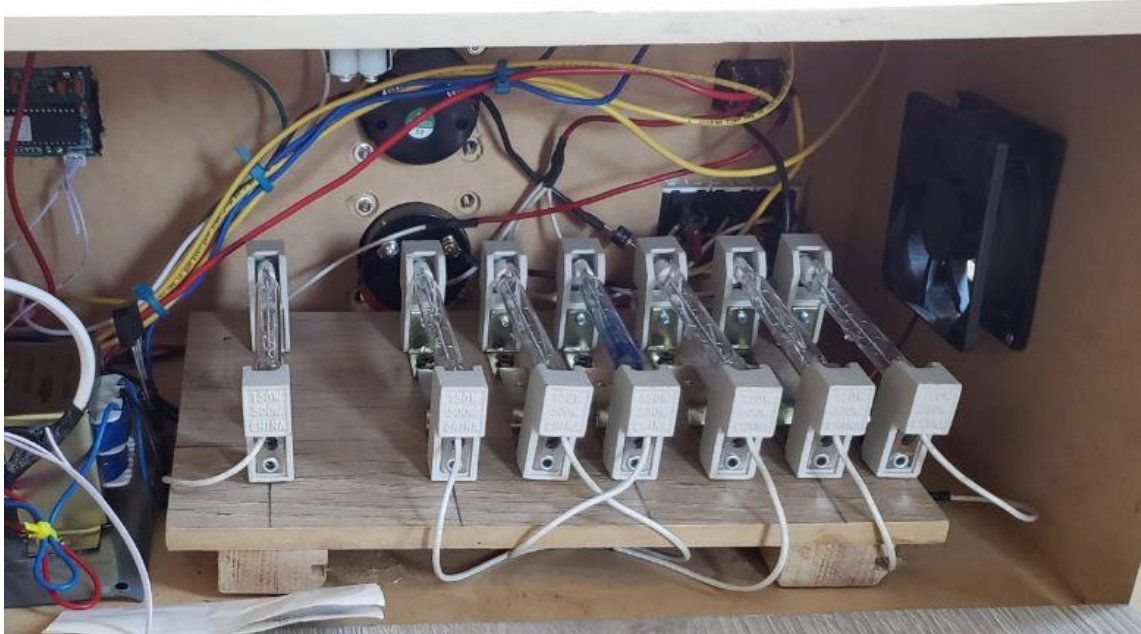
Ilustración 12. Consumidores alógenos para el procedimiento de descarga. Tomada por Carlos Álvarez y Luis Bastidas
