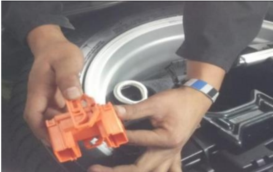
Ilustración 9. Desconexión del Jumper. (Gómez F. , 2014)
