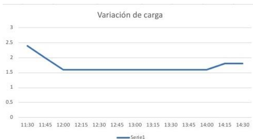
Ilustración 70. Curva de descarga de las celdas de Toyota Prius. Realizada por Carlos Álvarez y Luis Bastidas. 31/08/2020
