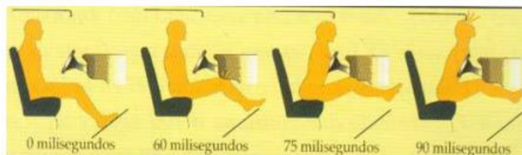
Figura 3.7 – Movimientos del ocupante durante un choque a 50 km/h
