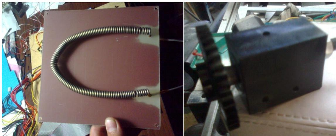
*Colocación del calentador resistivo de la base y colocación del engrane en estructura de rueda motriz*
