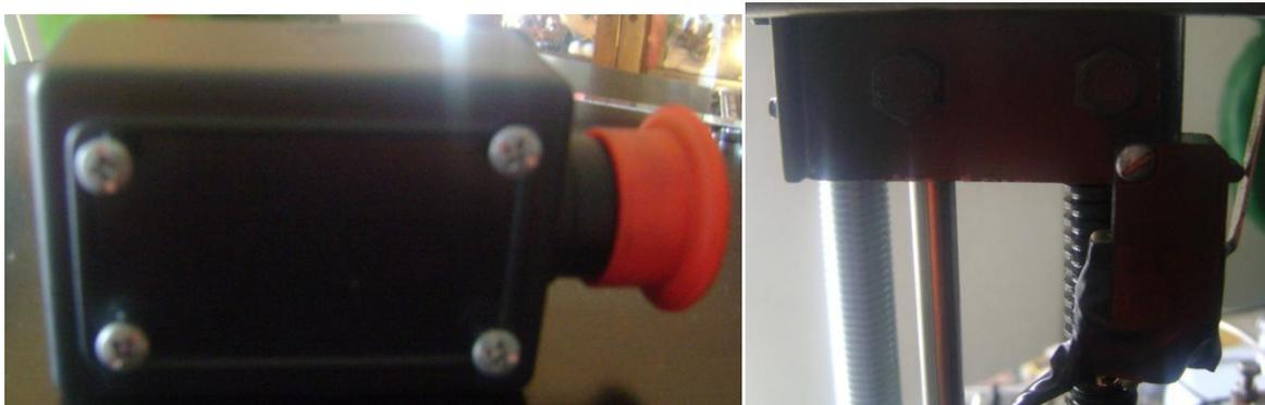
*Montaje pulsante de parada del sistema y colocación del final de carrera eje X*
