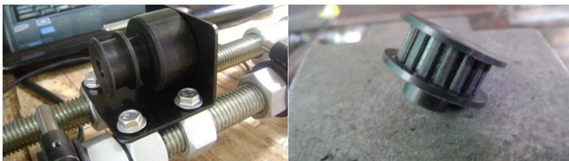
*Montaje de polea libre y rueda acanalada dentada ensamblada*
