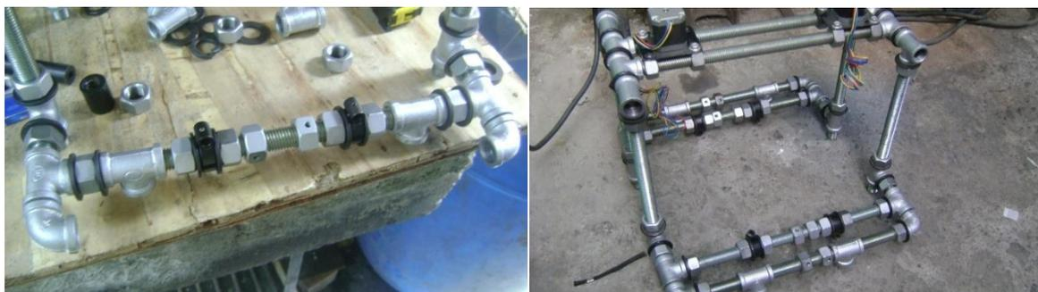
*Colocación de bocines para guías del eje Z y estructura roscada ensamblada*
