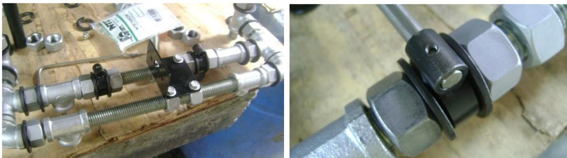
*Montaje base para polea libre del eje Y y montaje de guías para el eje Y*
