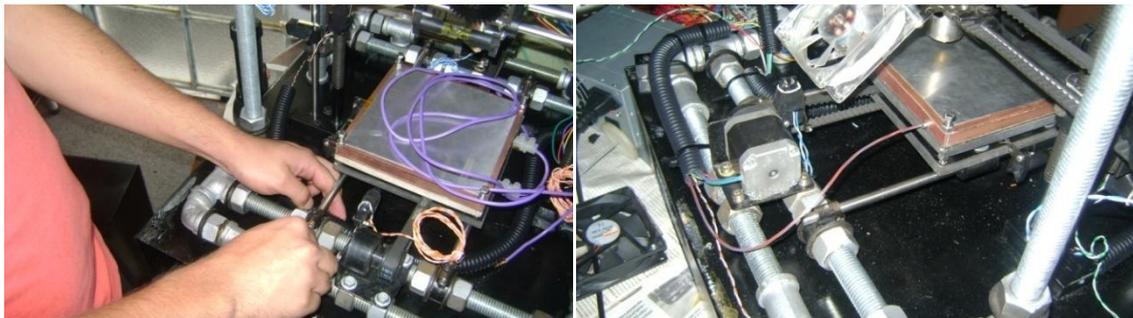
*Colocación de finales de carrera en el eje Y con su cableado y montaje del sensor de temperatura en la caja de calentamiento*
