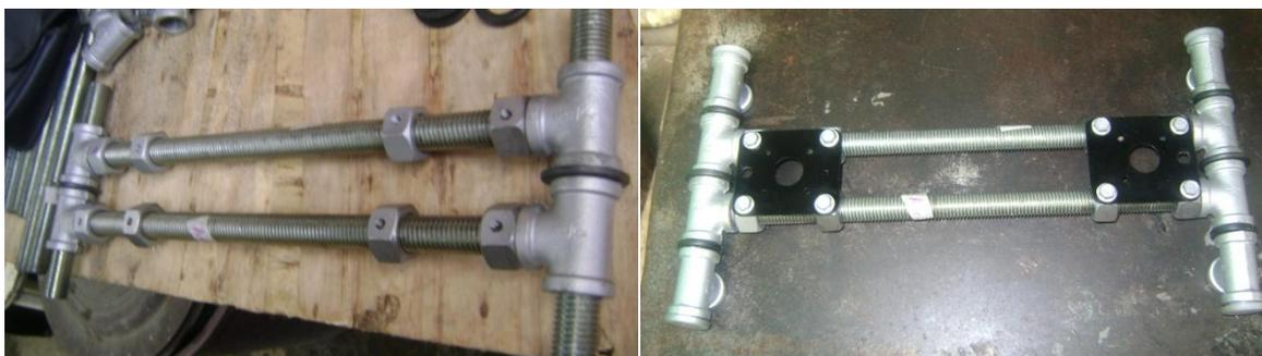
*Montaje de sujetadores roscados con varillas roscadas y colocación de las bases para los motores del eje Z*
