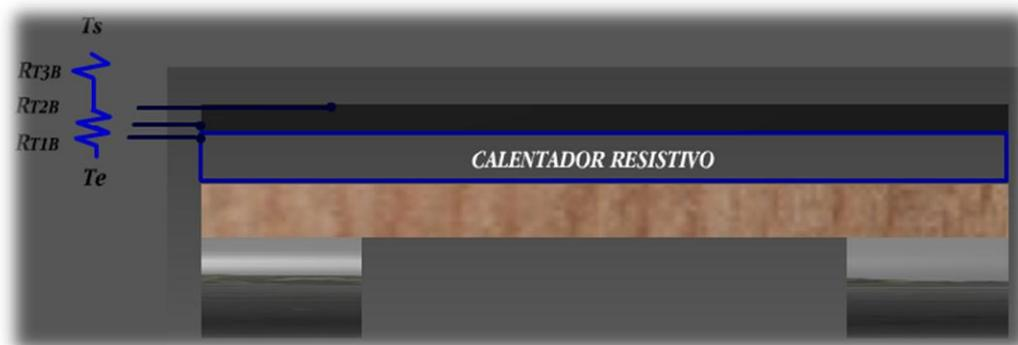
Figura 3.25: Esquema de resistencias térmicas del calentamiento del sólido en fabricación
