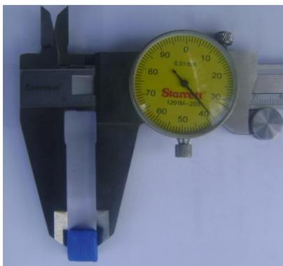
Figura 5.3: Medición con calibrador del cubo de prueba
