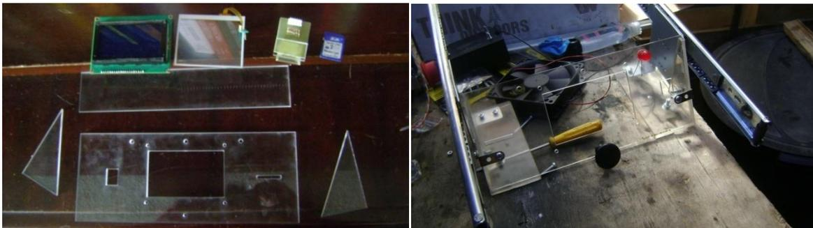
*Piezas de la interfaz cortadas y estructura de acrílico de la interfaz montada en el mecanismo guía*
