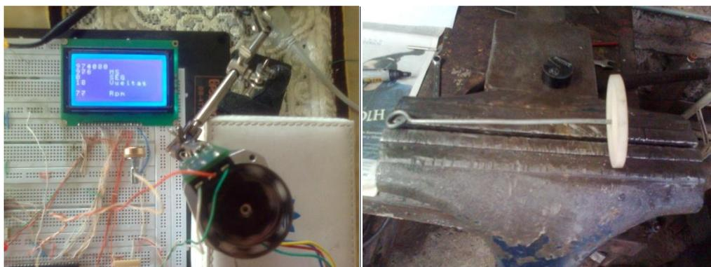
Figura 37.7: Pruebas de torque dinámico motor a pasos Nema 17.
