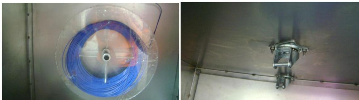
*Carrete con material cargado y sistema guía de material mediante garruchas adaptadas*
