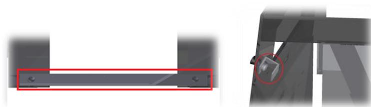
Figura 3.55: Metales para sistema imantado (Vista superior y vista inferior de cada metal respectivamente)
