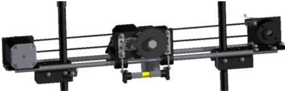
Figura 3.30: Carro eje X
