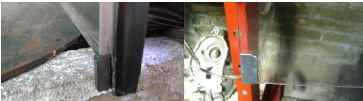
*Colocación del juego de imanes inferiores para la compuerta de acrílico*
