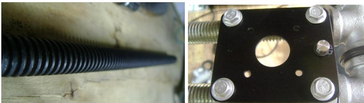
*Tornillo de potencia seleccionado y colocación de la guía para el eje Z*
