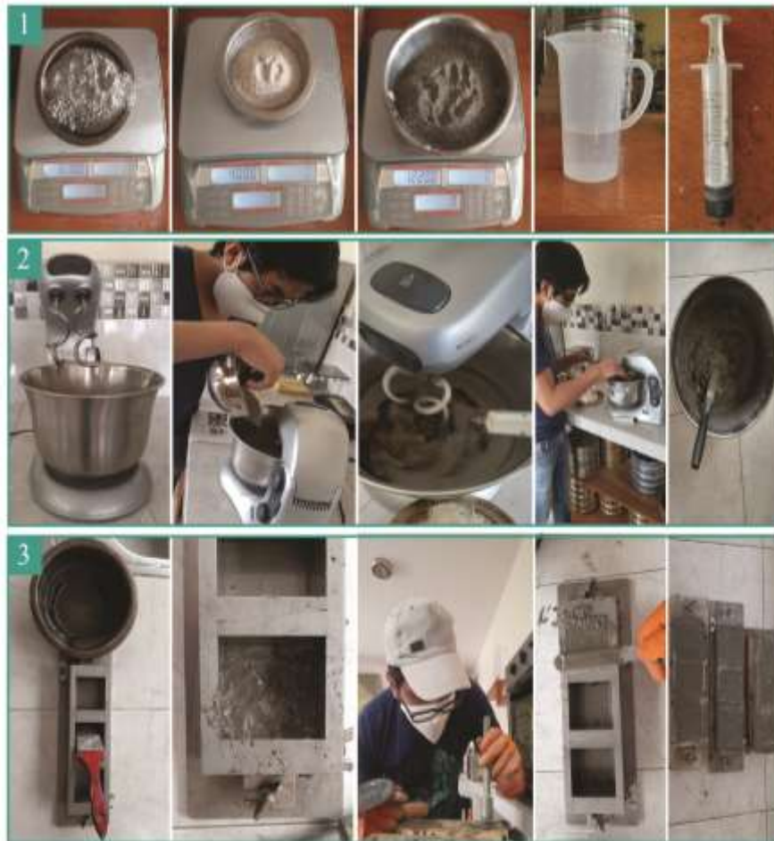
Figura 40. Procedimiento mezcla para ensayos a compresión
