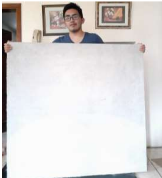
Figura 55. Panel de Micro Hormigón Reforzado con Fibras de Cabuya
