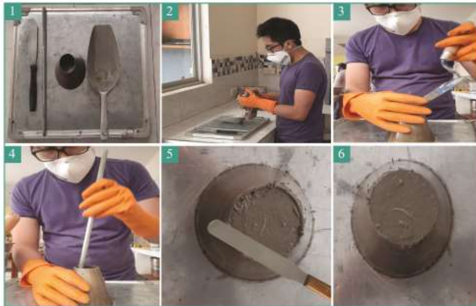
Figura 32. Procedimiento Ensayo de Asentamiento de Mezcla
