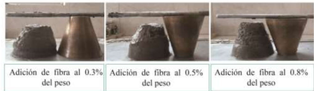
Figura 33. Resultados Asentamiento Cono de Abrams
