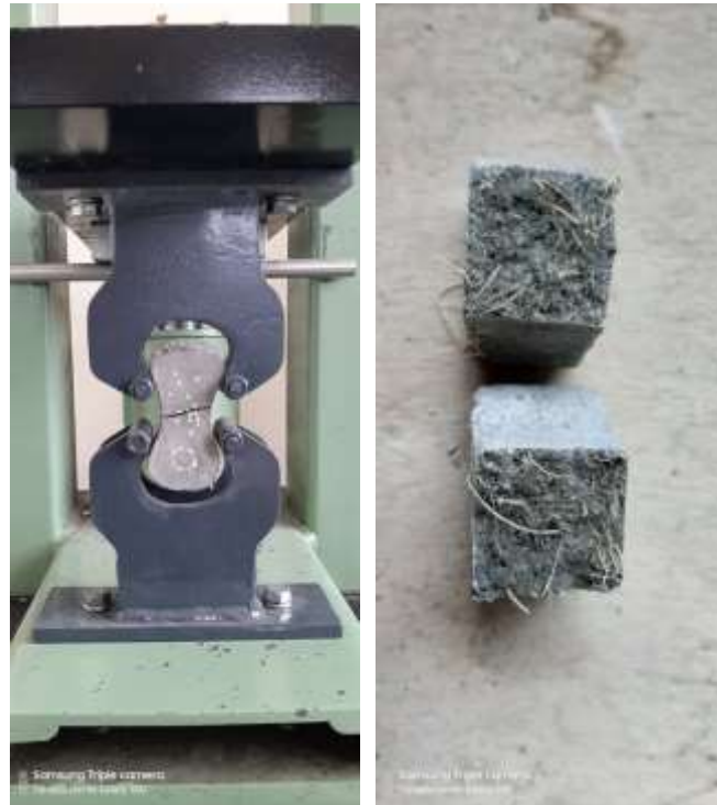
Figura 47. Resultado Resistencia a la Tracción
