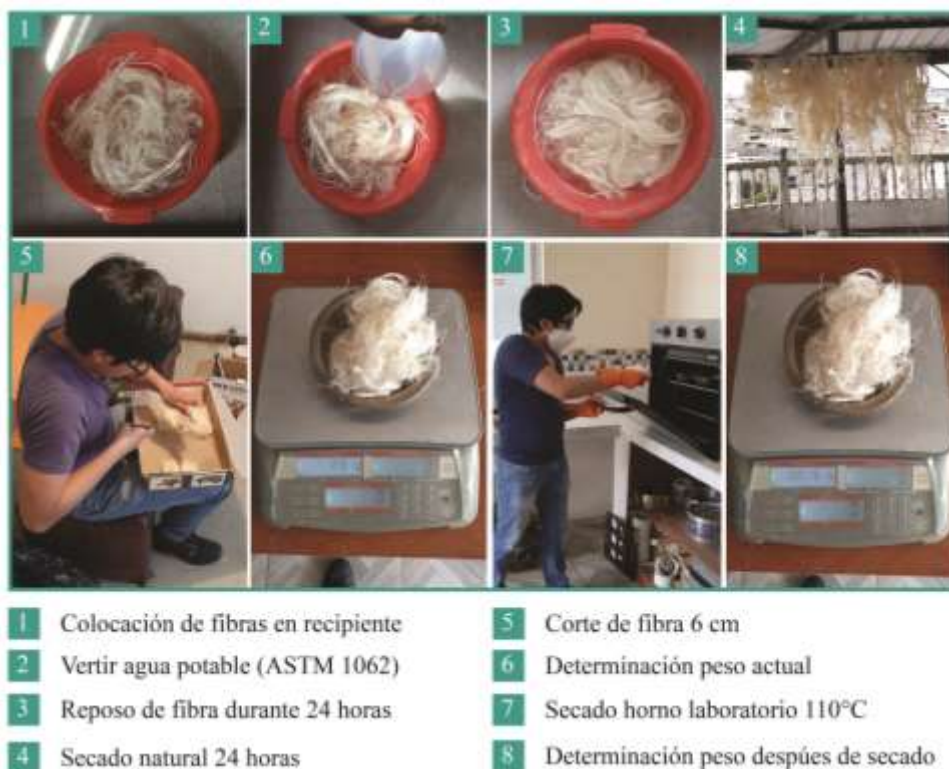
Figura 28. Procedimiento para eliminar impurezas de la fibra de cabuya
