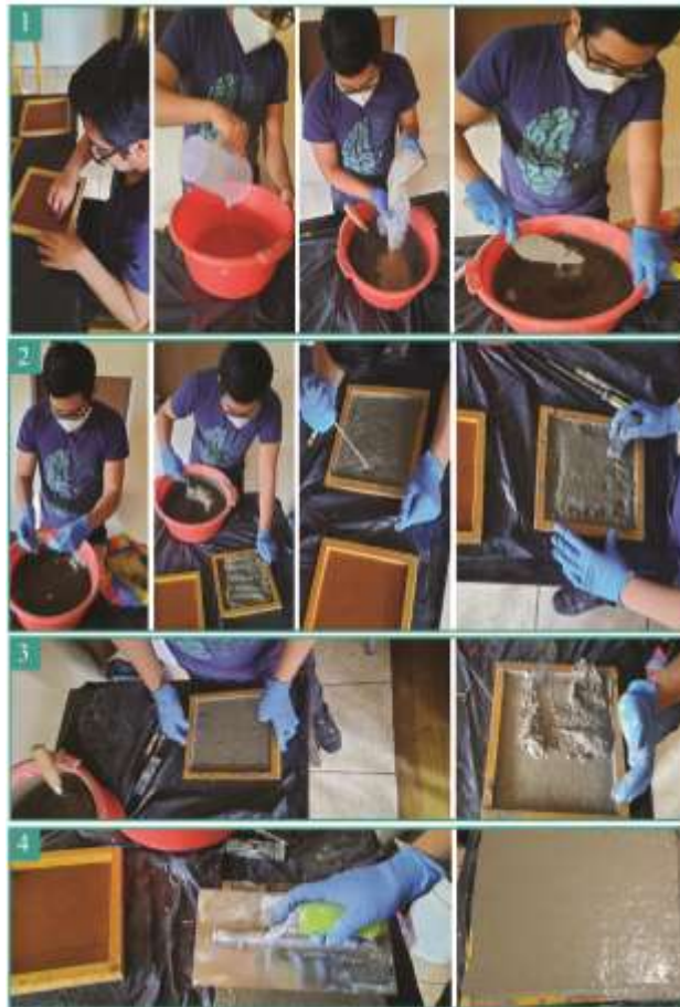
Figura 50. Procedimiento para Muestras de Panel de Micro Hormigón a los 7,14 y 28 Días
