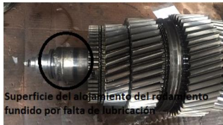
Rodamiento y pista derodamiento fundido por falla en la lubricación
