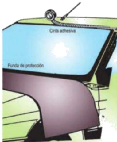
Figura 7.44. Protección del perímetro del marco.
