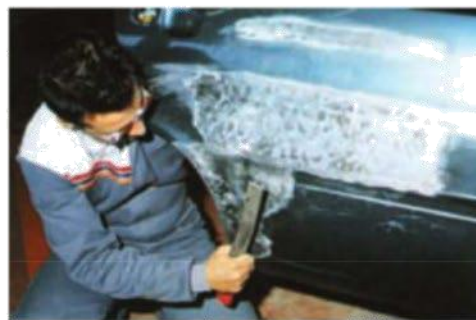
Figura 8.37. Repaso con la espátula para eliminar tensiones.
