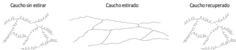
Figura II-5. Moléculas poliméricas de caucho al ser estiradas.
