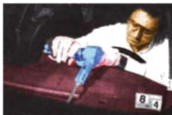
Figura 7.50. Utilización de la cortadora desde el interior del vehículo.
