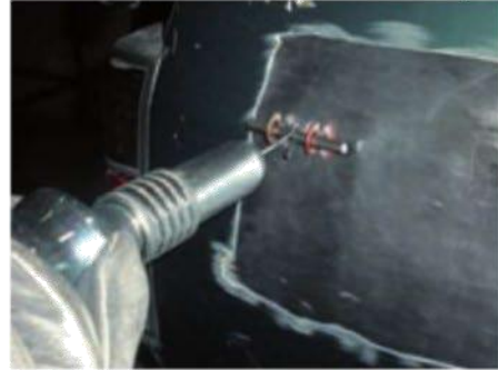
Figura 8.48. Retracción de la chapa mediante la utilización de arandelas, pasador y martillo de inercia.
