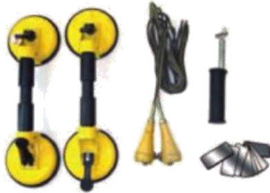
Figura 7.34. Útiles para el montaje de lunas calzadas.
