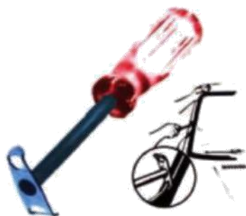
Figura 7.41. Útil para colocar el junquillo embellecedor.
