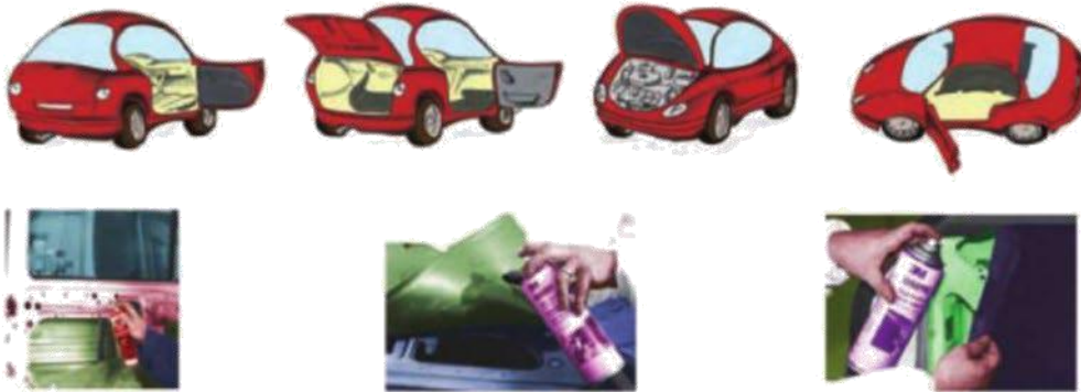
Figura 5.97. Los adhesivos en spray ofrecen una elevada fuerza de adhesión inmediata. Se utilizan para pegar gran número de materiales como tejidos, espumas de poliéster, perfiles de caucho (molduras), metales, etc.
