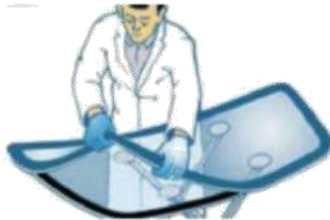
Figura 7.35. Forma de introducir la goma de contorno sobre la luna calzada.
