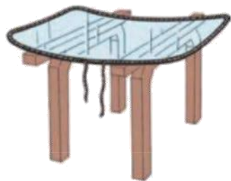
Figura 7.36. Colocación de una cuerda dentro de la ranura de la goma de contorno.
