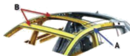
Figura 4.64. A, larguero de techo; B, traviesas de techo.
