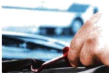
Figura 7.40. Utilización de un gancho para facilitar la colocación de la goma de contorno.
