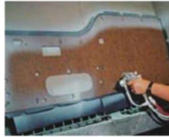
Figura 5.98. Aplicación de adhesivos de base acuosa.
