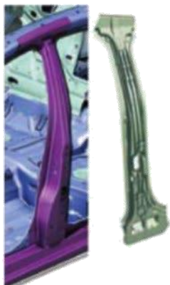
Figura 4.66. Montantes y pilares.
