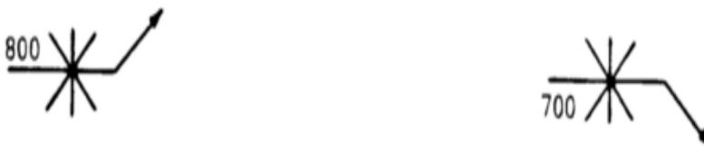
El paso de las soldaduras por puntos de resistencia se debe mostrar a la derecha del símbolo de soldadura (Figura 26).
