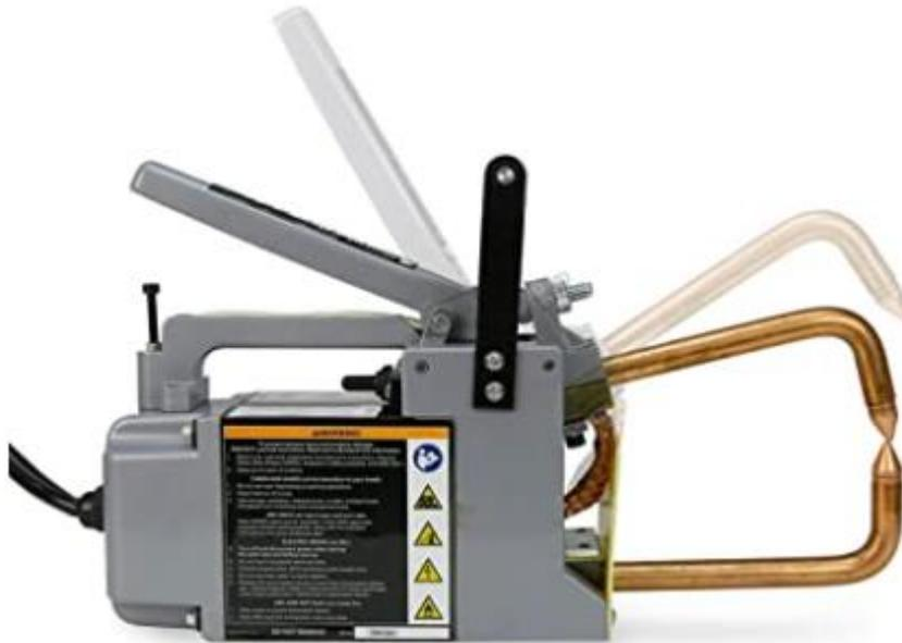
El equipo elemental necesario para la soldadura por puntos consiste en la estación de trabajo que incluye la fuente de alimentación de soldadura y el cabezal de soldadura al que se conectan los electrodos de soldadura. Los electrodos de soldadura están hechos de cobre por su buena capacidad conductora.
