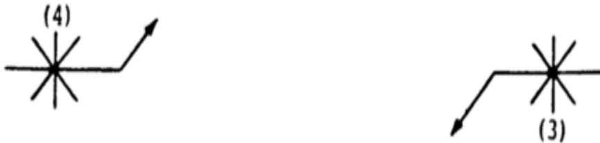
Cuando la superficie expuesta de un miembro de una junta soldada por puntos de resistencia debe quedar al ras, esa superficie se indicará agregando el símbolo de contorno al símbolo de soldadura (Figura 28) de acuerdo con las especificaciones de ubicación.
