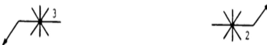
Cuando se desea un número definido de soldaduras en una unión determinada, el número debe mostrarse entre paréntesis, ya sea arriba o abajo del símbolo de soldadura (Figura 27).
