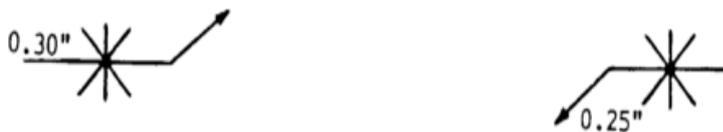
La fuerza de las soldaduras por puntos de resistencia se designa como la resistencia al corte mínima aceptable en libras por punto y debe mostrarse a la izquierda del símbolo de soldadura (Figura 25).
