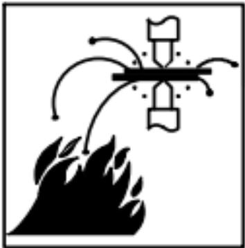
Pueden salir chispas del arco de soldadura. El vuelo chispas, piezas de trabajo y equipos calientes pueden provocar incendios y quemaduras.
