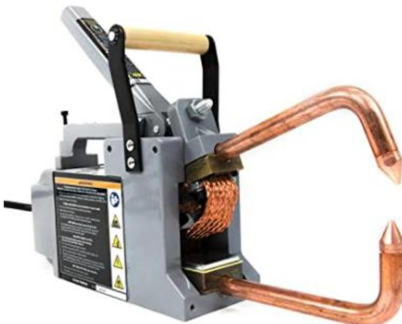
Puntas de repuesto: el soldador puntual viene con un par extra de puntas de soldadura para múltiples usos. Simplemente gira las puntas cuando estén listas para ser reemplazadas y atornilla la nueva (Figura 52).
