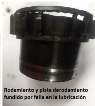
Superficie del alojamiento del rodamiento fundido por falta de lubricación
