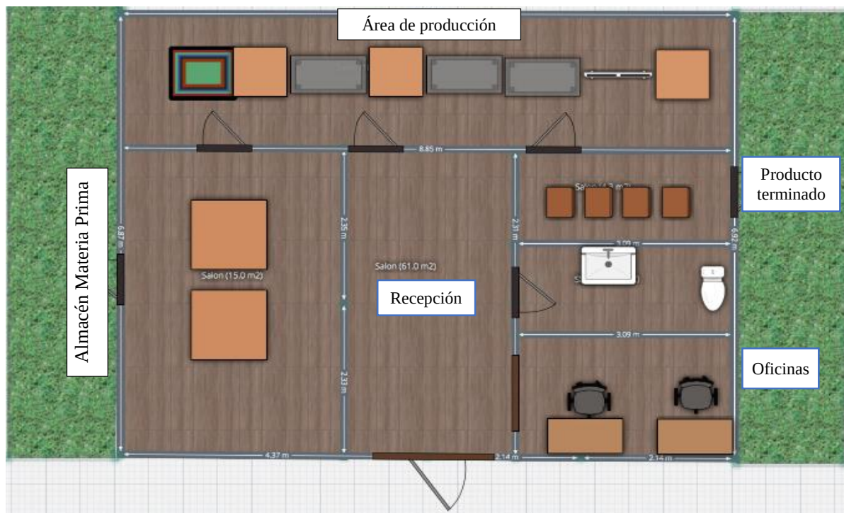
Figura 23. Distribución de la planta de producción en 300 [m 2 ]
