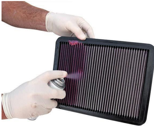
Figura 18. Ejemplo de humectación de un filtro de alto rendimiento. (Muñoz, 2017)
