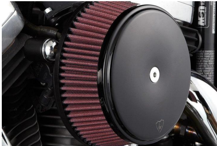
Figura 15. Filtro textil de alto rendimiento (Muñoz, 2017)
