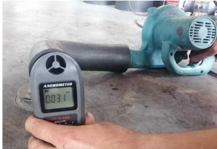
Figura 39. Medición de velocidad de aire a ralenti. Autores
