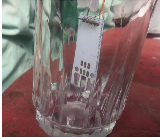
Figura 48. Calibración cero del sensor. Autores
