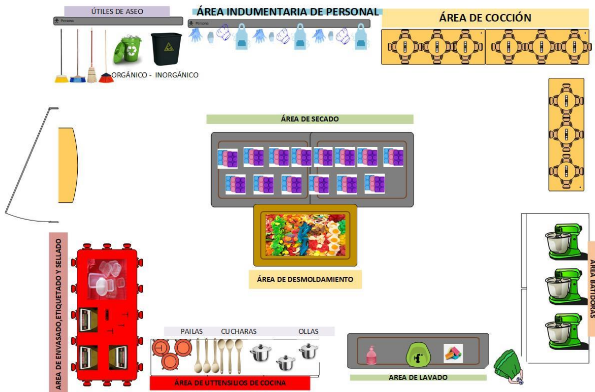
Ilustración 14 Distribución del área de producción
