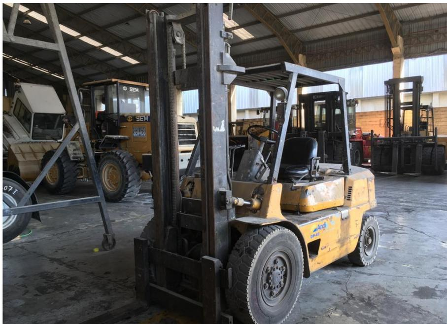
Figura 22. Montacargas GP-40 4 toneladas
