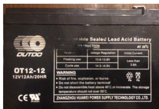
Figura 30. Batería de 12 VDC
