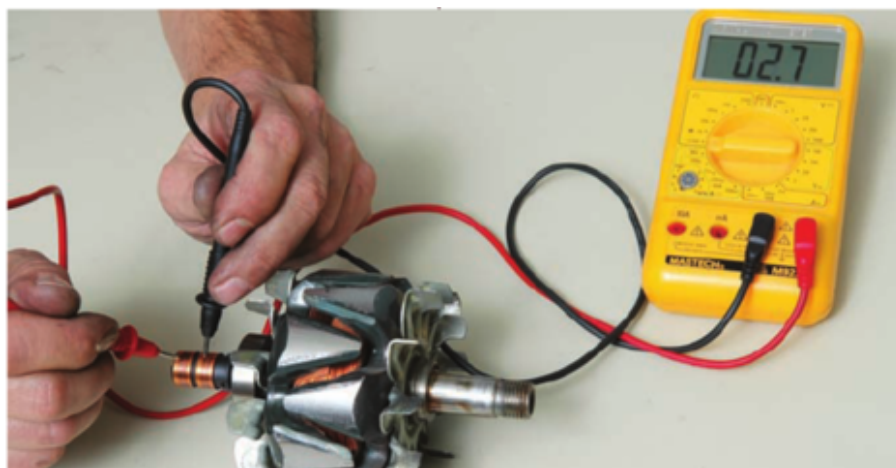
Figura 13. Comprobación de continuidad en la bobina del rotor [5]
