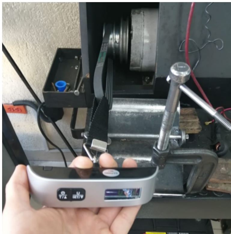
Figura I.2. Toma de medidas de fuerza para tensado de banda
