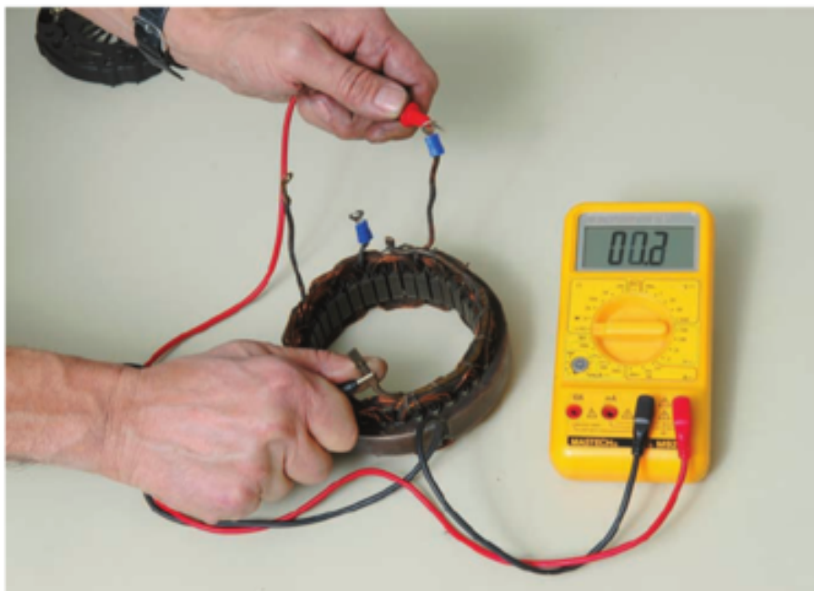
Figura 16. Comprobación de continuidad de las bobinas inducidas conectadas en estrella [5]
