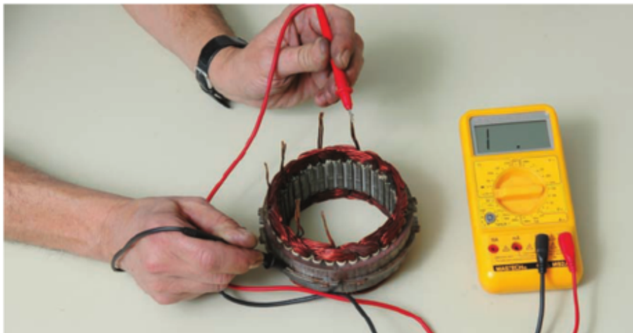
Figura 14. Comprobación de aislamiento de la bobina inducida y masa [5]
