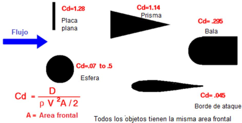
**Figura 13.** Coeficientes de drag para diferentes perfiles.
