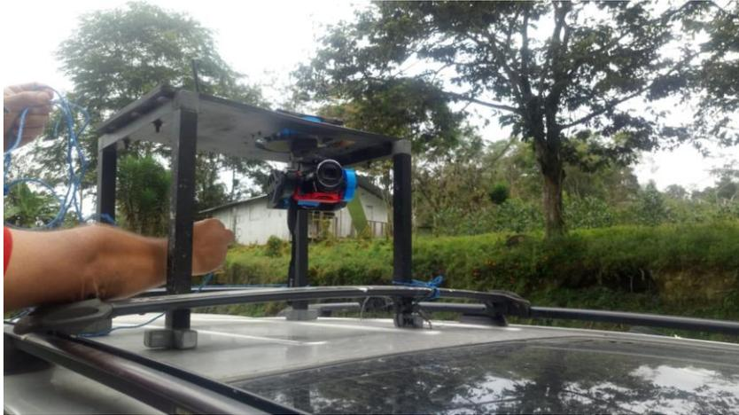
**Figura 45.** Incorporación de sistema de estabilización sobre vehículo.
