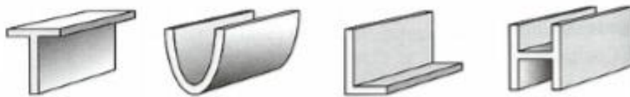
Figura 2. Perfiles utilizados en carpintería metálica [6]
