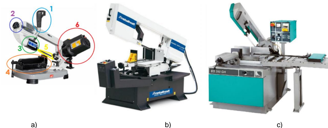
Figura 1. Componentes principales de sierra de cinta a) manual b) semiautomática c) automática [2]
