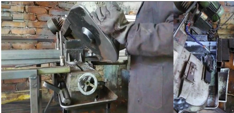
Figura 10. Corte del material.
