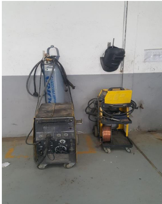
Imagen 16: Soldadoras eléctrica y autógena para trabajos de latonería
