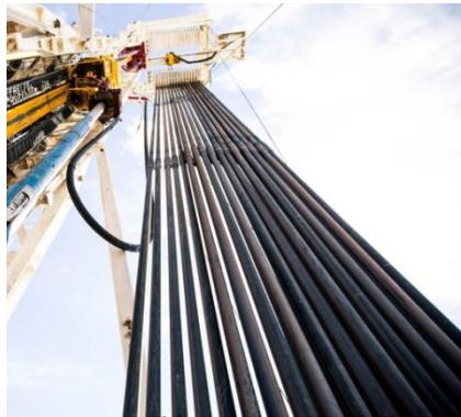
*Figura 6. Tubería de perforación 5-1/2”*
