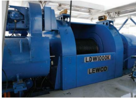
*Figura 3.* Malacate AC de perforación Lewco
