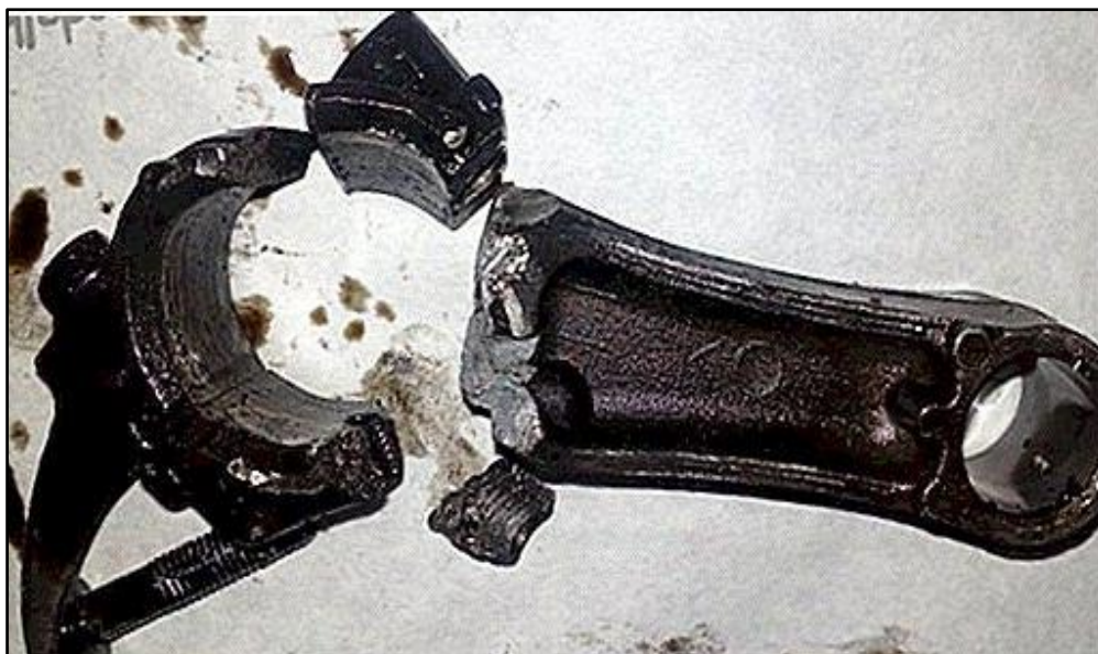
Figura 6. Brazo de biela en fractura motor Honda GX160.
