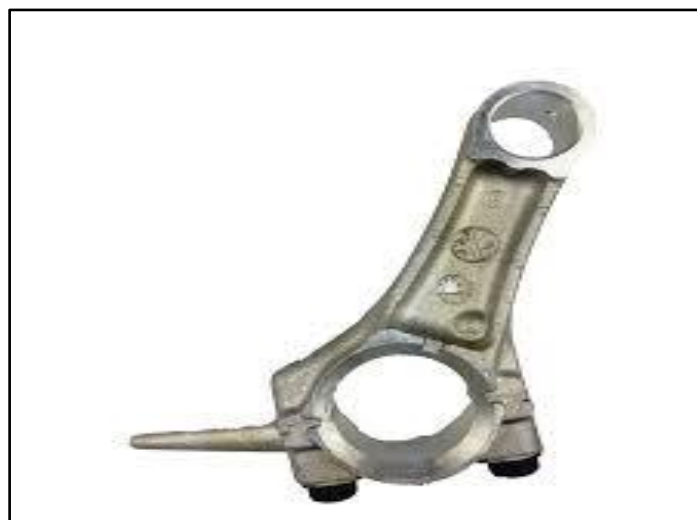
Figura 27. Biela aligerada en aleación de aluminio Honda GX 160.
