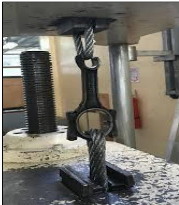
Figura 52. Esfuerzos de tracción al que se somete un brazo de biela.
