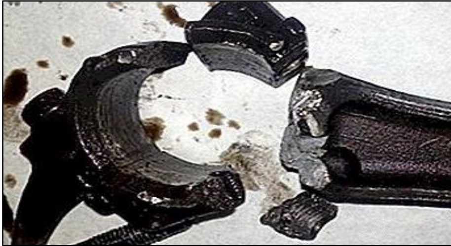
Figura 56. Brazo de Biela fracturada
