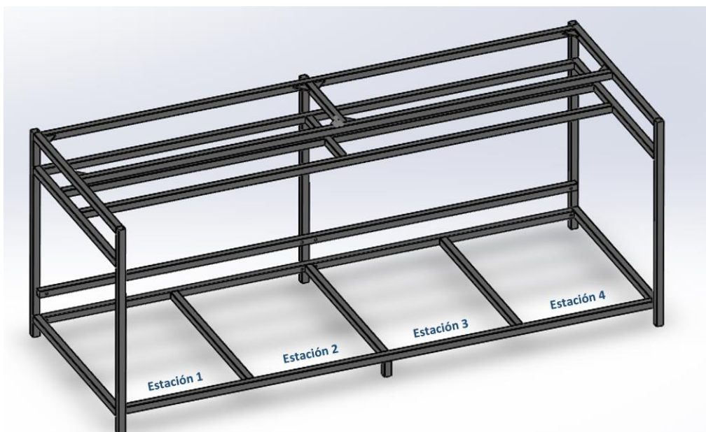
Figura 2 Esquema inicial de la estructura del envasador
