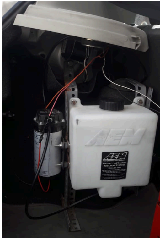
Figura 16 Conjunto de bomba, tanque de almacenamiento y base de sujeción
