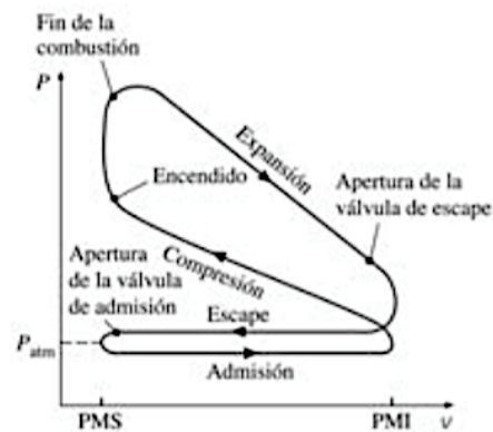
Figura 4 Ciclo real del motor Otto
