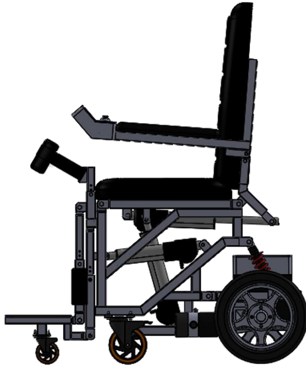
Figura 14. Diseño geométrico posición sedente.
