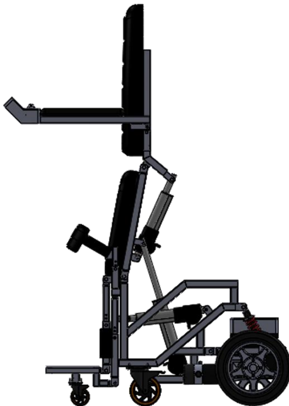
Figura 15. Diseño geométrico posición de bipedestación
