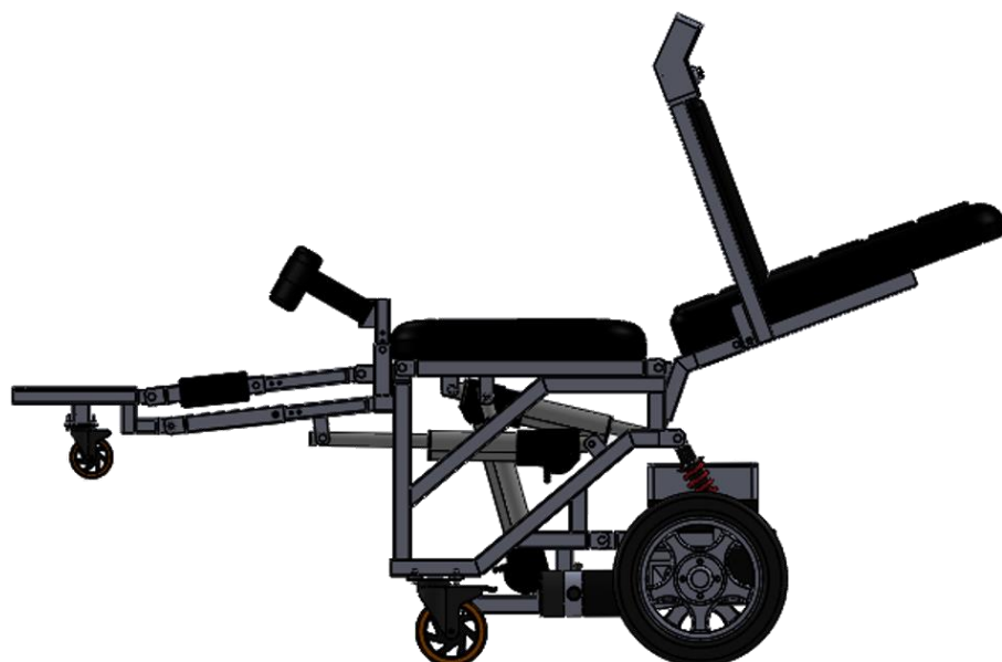
Figura 16. Diseño geométrico posición decúbito
