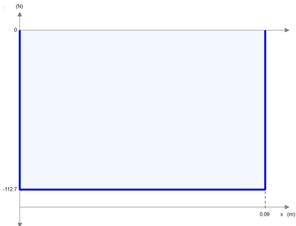
**Figura 17. Diagrama de cortantes de la viga en voladizo**
