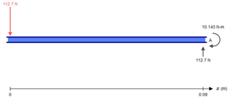
**Figura 16. Diagrama de cuerpo libre para la viga en voladizo**
