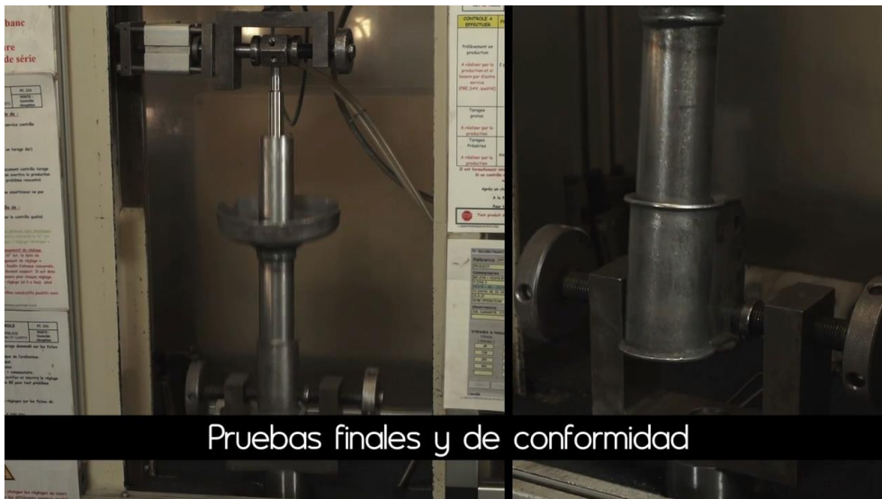
Imagen 23. Control de Calidad y Esfuerzos al Amortiguador Fuente: www.record-france.fr
