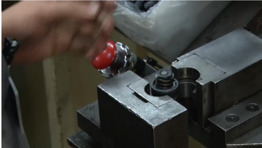
Imagen 20. Ensamblaje y Unión de Componentes del Amortiguador. Fuente: http://www.record-france.fr
