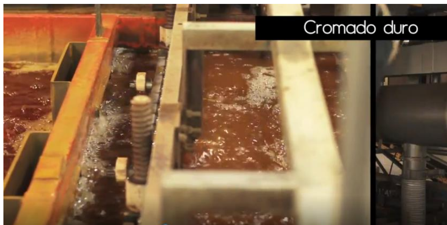
Imagen 14. Tratamiento de cromado del Vástago del Amortiguador. Fuente: http://www.record-france.fr
