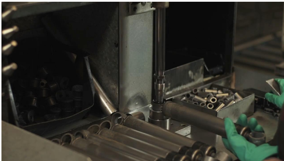
Imagen 22. Colocación de Bujes al Amortiguador Fuente: www.record-france.fr
