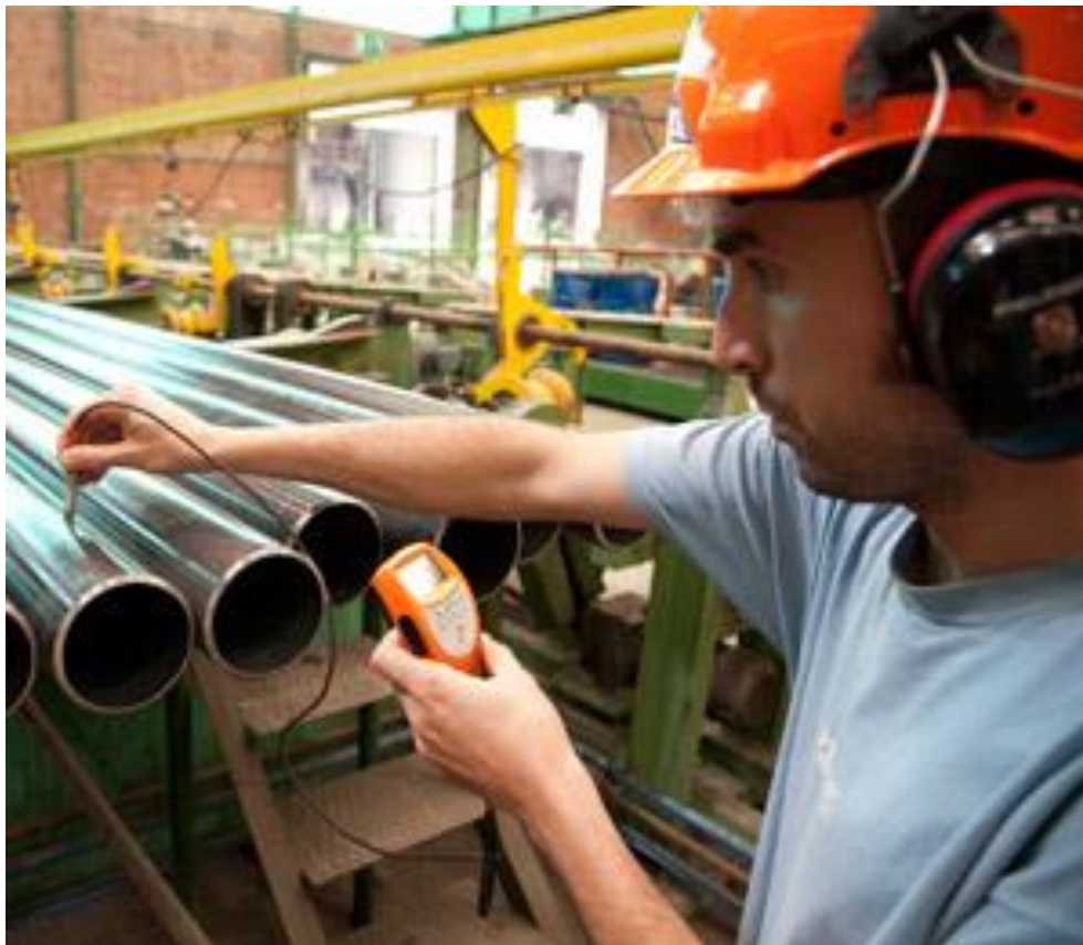
Imagen 8. Control de Calidad para Tubos de Componentes. Fuente: www.tubosreunidos.com
