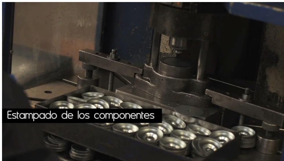
Imagen 16. Estampado de Componentes del Amortiguador. Fuente: http://www.record-france.fr
