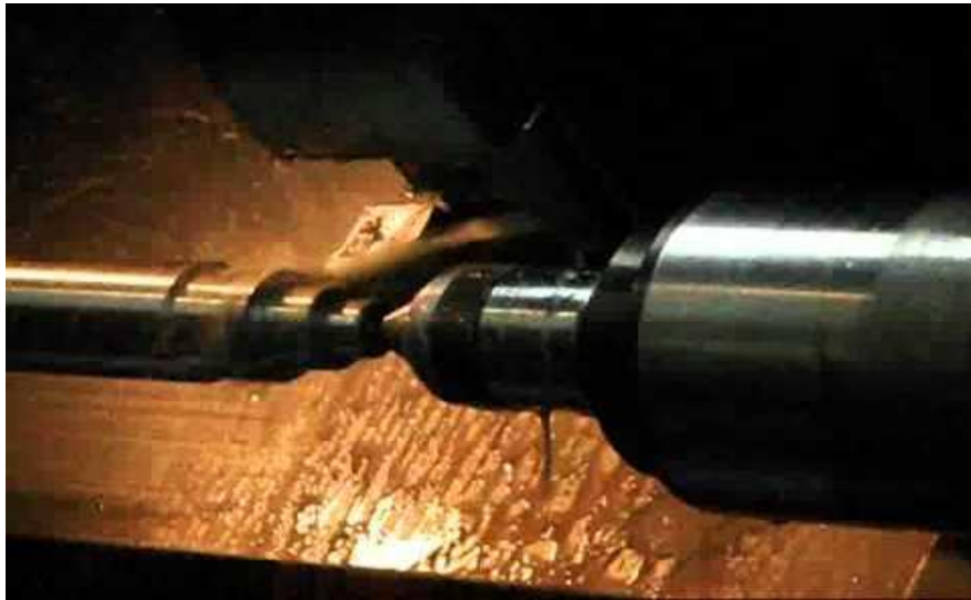
Imagen 12. Corte y Maquinado del Vástago del Amortiguador. Fuente: http://www.record-france.fr
