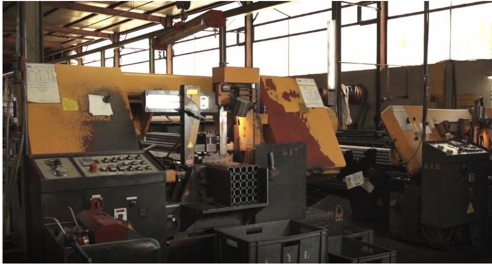
Imagen 9. Corte de Tubos de Componentes. Fuente: Record France
