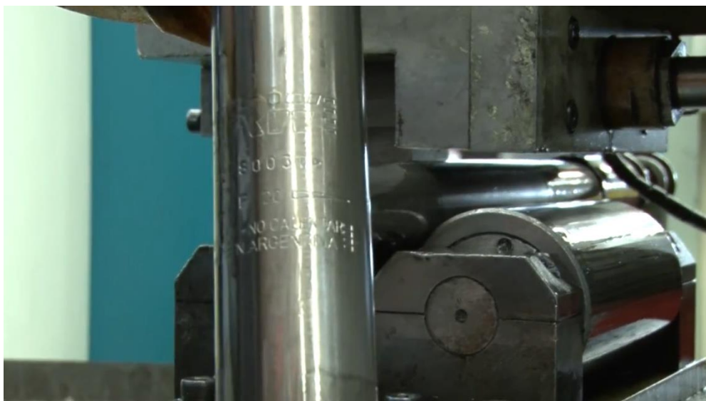
Imagen 10. Troquelado de Datos en Tubo. Fuente: talleractual.com fabrica Corven
