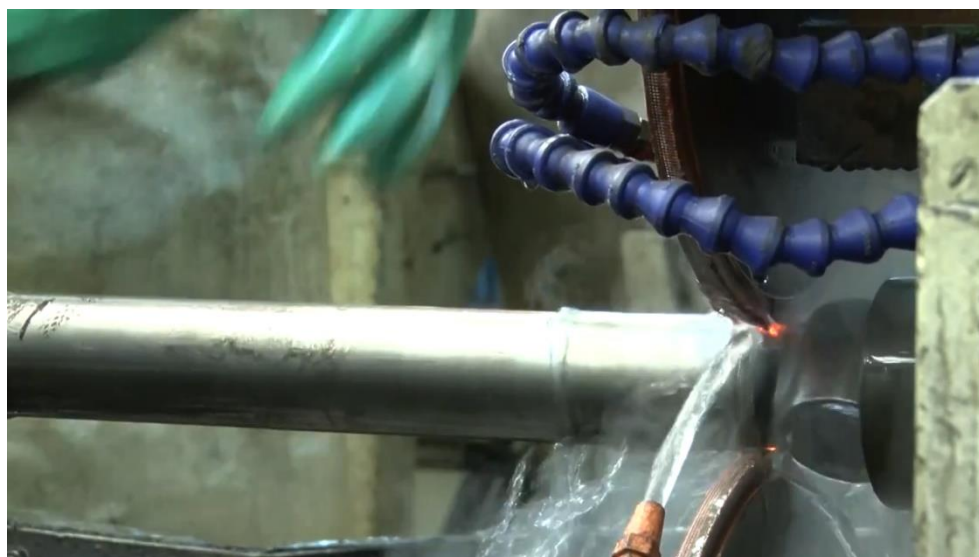
Imagen 17. Soldadura de Componentes del Amortiguador. Fuente: http://www.record-france.fr
