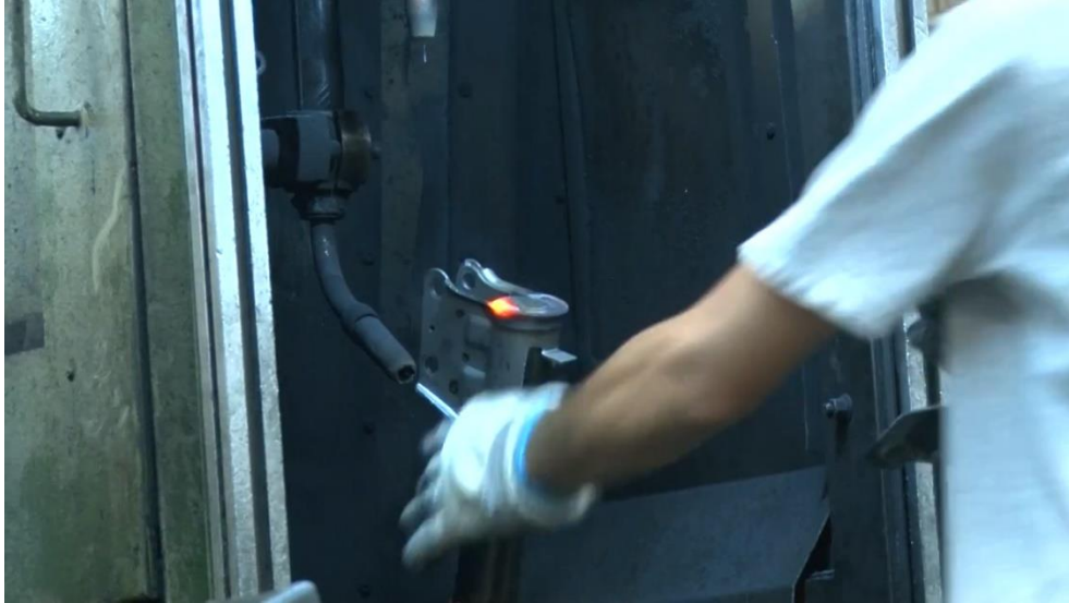
Imagen 18. Soldadura de Soportes Amortiguador McPherson. Fuente: talleractual.com Fábrica Corven
