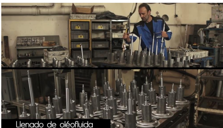
Imagen 21. Proceso de Llenado de Líquido Hidráulico al Amortiguador Fuente: www.record-france.fr
