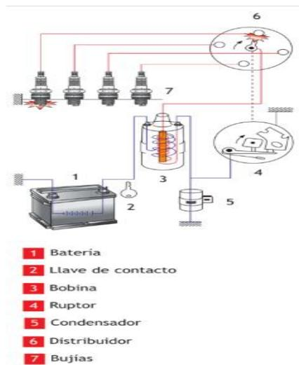
**Figura 5.** Distribuidor mecánico
