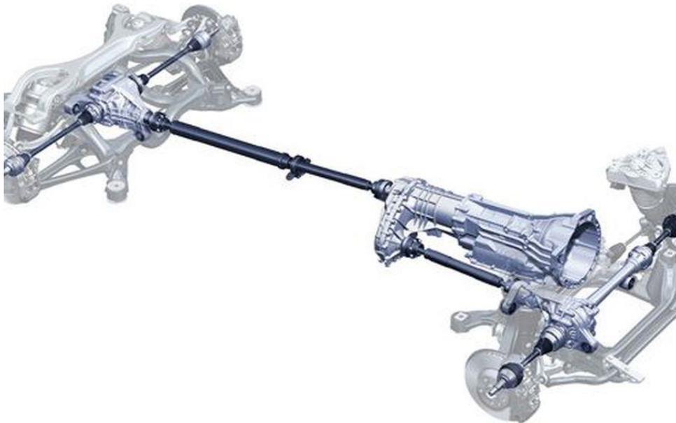
En el caso de una tracción total permanente es necesario al menos un diferencial en cada eje, mientras un diferencial central (p. ej., Torsen, Haldex) distribuye la carga entre los ejes. Hoy en día, estos acoplamientos y bloqueos automáticos se regulan electrónicamente a través de diferentes parámetros de carga y dinámica de movimiento y hacen posible una distribución variable de la fuerza.
